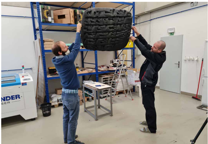
Příprava poutače na výstavu: 50x zvětšené klínopisné tabulky spleené z vrstev PU pěny vyřezaných laserem podle digitálního 3D modelu.
