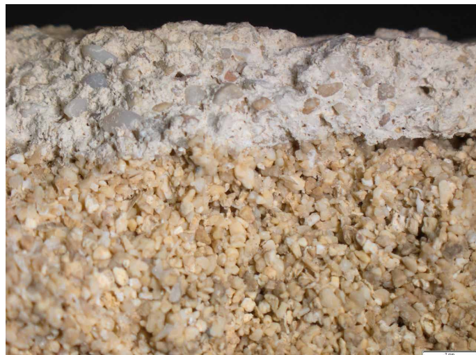
Vzorek YSC 18, sádrová malta položená na pískovec. Vzorek byl odebrán na ostrově Yeronisos a předpokládá se, že pochází z helénistického období. Foto: P. Pizzo
