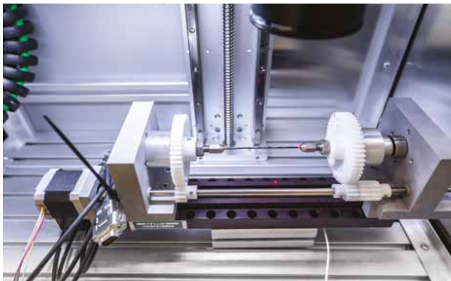
Tepelná úprava superelastického drátu z nitinolu pomocí laseru. Drát napnutý na požadovanou délku rotuje kolem své osy a posouvá se k laserovému svazku.
