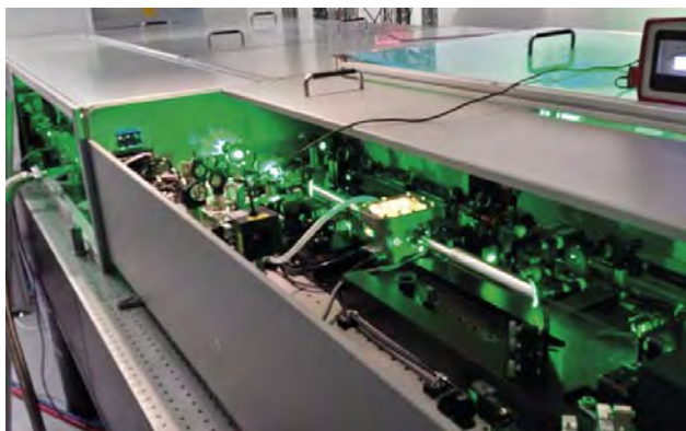
■ Obr. 6 Zprovozněný systém oscilátoru a předzesilovačů pro laserový systém L3, vyvinutý na základě specifikací FZÚ a LLNL. Jednotka poskytuje pulsy s energií 5 mJ o délce cca 25 fs, s opakovací frekvencí 100 Hz.
