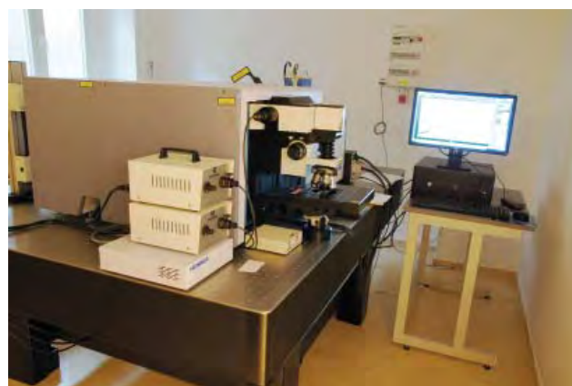
■ Obr. 6 Pohled do nové sklepní laboratoře projektu LABONIT. Na antivibračním optickém stole je umístěn Ramanův a fotoluminiscenční spektrometr Scientific LabRAM HR od firmy Horiba.
