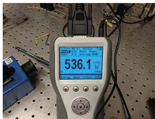
■ Obr. 6 Výstupní výkon a účinnost v základním prostorovém módu na výstupu druhého stupně Beamline C v kontinuálním režimu (nahore). Podařilo se stabilně generovat >500 W, čímž jsme prokázali schopnost komponent pracovat v systému s vysokým středním výkonem.
