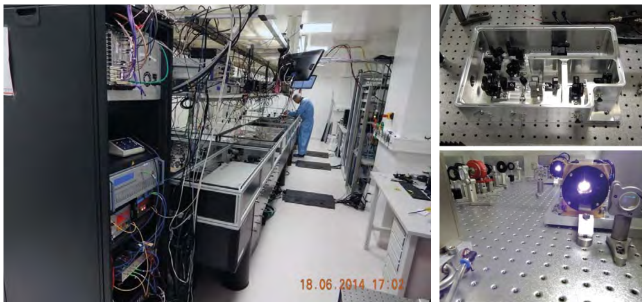
Obr. 1 Pohled do vývojové laboratoře laserového systému L1 zachycující instalované systémy první části řetězce L1, která bude koncem roku 2015 instalovaná v budově ELI Beamlines. Snímky vpravo zachycují systém femtosekundové synchronizace laserových pulsů, vyvinutý oddělením 91 (v r. 2014 podána patentová přihláška) a regenerativní laserový zesilovač na bázi tenkých disků, spolu s profilem výstupního laserového svazku.
