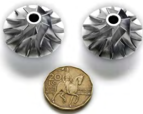
■ Obr. 3 Rychloběžné miniaturní turbíny kompresoru Braytonovy kryogenní jednotky pro čerpací laser 10 J 10 Hz prvního stupně laserového systému L2. Vpravo jsou fotografie implementované kryogenní jednotky typu Brayton pro chlazení aktivního prostředí laseru na teplotu cca 150 K; jednotka byla vyvinuta ve spolupráci s firmou. Ateko, a. s.
