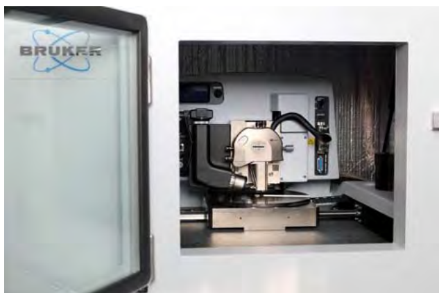
■ Obr. 4 AMF ICON od společnosti Bruker – detailní snímek měřící hlavy umístěné v antivibrační skříni a logo projektu vytvořené anodickou litografií.
