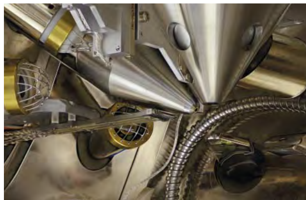
■ Obr. 15 Pohled do vakuové komory elektronového mikroskopu FERA 3 firmy Tescan zachycující objektiv elektronového tubusu, iontového tubusu, nanomanipulátor, GIS, detektory elektronů, iontů a katodoluminiscence.
