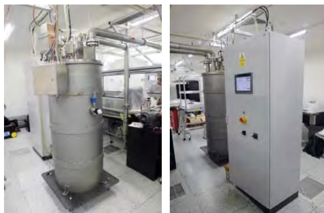
■ Obr. 3 Rychloběžné miniaturní turbíny kompresoru Braytonovy kryogenní jednotky pro čerpací laser 10 J 10 Hz prvního stupně laserového systému L2. Vpravo jsou fotografie implementované kryogenní jednotky typu Brayton pro chlazení aktivního prostředí laseru na teplotu cca 150 K; jednotka byla vyvinuta ve spolupráci s firmou. Ateko, a. s.
