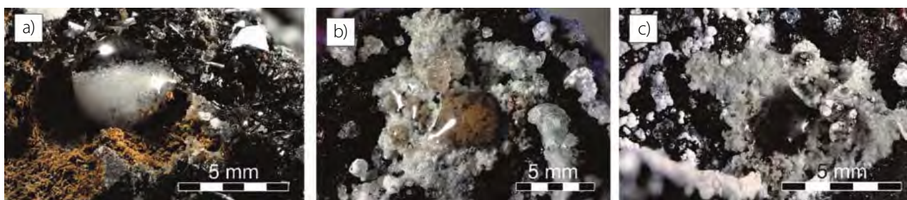
■ Obr. 4 Vznik minerálu kaatialaitu (bílé krystalky) z As-bohatého roztoku (kapka) na povrchu zvětrávajícího ryzího As. a) Počáteční fáze – krystalky uvnitř kapky; b, c) pokročilá fáze – krusty kaatialaitu a zbývající roztok. Měřítka je přibližná.
