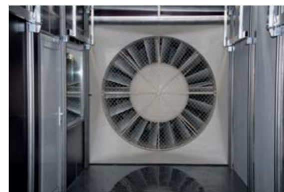
Klimatický tunel v Centru excellence Telč. Na snímku klimatizovaná komora s 200kW ventilátorem. Komora je připravena pro urychlení vzorků do otvorů v podlaze. Pohyblivý strop umožňuje operativní manipulaci s vodními tryskami či se sálavými lampami.
