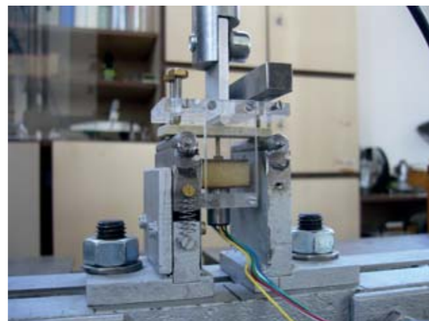
Zkoušení pevnosti v tahu za ohybu konsolidovaného plátku kamene Testování mechanických vlastností historických stavebních materiálů před a po jejich ošetření zpevňujícími prostředky je základní metodou, která umožňuje experimentálně zjistit konsolidační efekt zpevňujících látek napouštěných do věkem poškozených povrchů stavebních památek. (Ústav teoretické a aplikované mechaniky)
