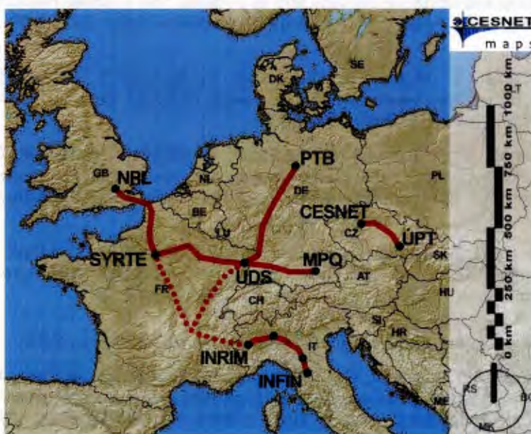
Obr. 3.: Přehled fotonických sítí s optickými vlákny pro přenos signálů atomových hodin nové generace v Evropě v roce 2016.
