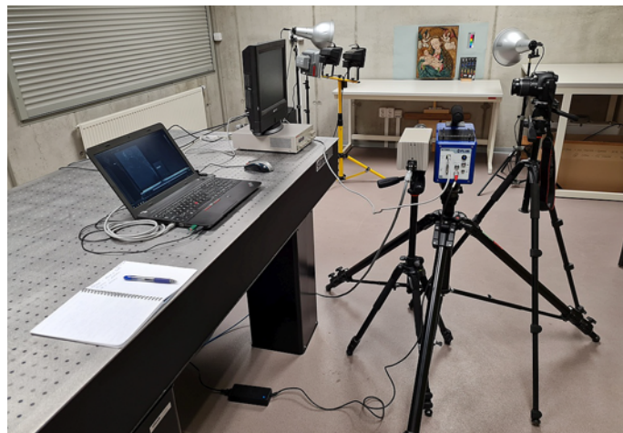
Sestava lamp s termokamerou a IR kamerou pro dokumentaci obrazu v telčské Laboratoři optických metod. Foto: J. Valach.
