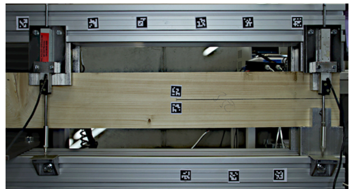
Sestava experimentu pro smíšený mód je označena aruco markery pro zjištění celkové tuhosti optickými metodami.
