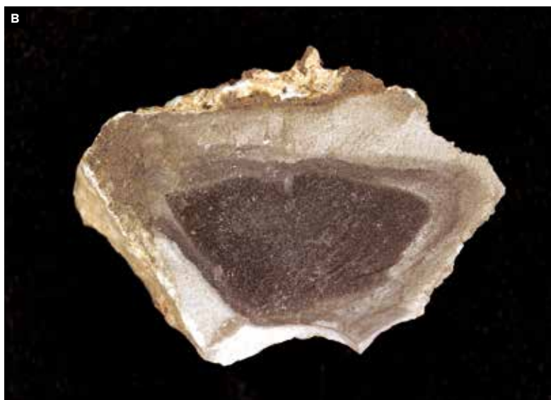
11 Vzorek pojivového kusu obaleného maltou o velikosti přibližně 4 cm z místa proražení hradební zdi (A). Jedná se o celistvý kus neúplně vypáleného vápence. Původní surovina se zachovala ve středu kamene a tvoří tmavší jádro, které zůstalo nevypáleno. Kolem jádra jsou bílé části vypáleného, ale soudržného materiálu (B). Průřez románskou hradební zdí, Pražský hrad, vzorek PH 1.
