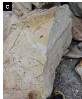
31 Dokumentace množství svrchu odebraného materiálu do hloubky asi 20 cm pod vrchem pece, který nebyl zcela vypálen (A), odebíraného vápna s tmavším nedopáleným jádrem (B) a kusu plně vypáleného vápna z klenby topeniště (C). Výpal zlíčovského vápence z r. 2016.
