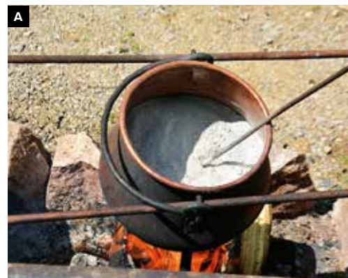
37 Dokumentace vaření sádry v kotlíku nad ohněm (A) a projev varu, kdy unikající vodní pára vytváří malé krátery (B). Výpal preinsfeldského sádrovce na nízkou teplotu v r. 2019.
