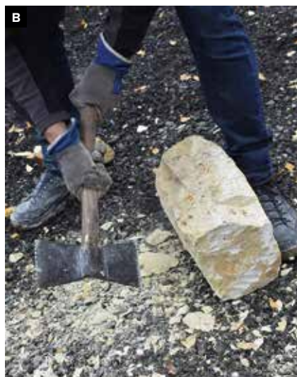
13 Hrubé opracování opuky na kvádry v lomu. Jednotlivé kameny se rozdělily na skupiny podle výšky a z předpokládané lícové strany upravily do roviny. Aby se podařilo udržet pravý úhel mezi čelem a spodní nebo horní stranou kamene, musel se použít úhelník (A). Právě natěžený kámen se formátoval ručními nástroji včetně funkčních replik vyrobených podle středověkých vzorů: plošiny s břitem a plochými zuby (B) a špicplošiny (C).
