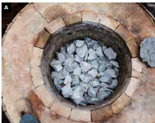
36 Dokumentace množství a velikosti sádrovcových kamenů v peci před výpalem (A) a sádrovec svrchu vsázky po výpalu (B). Výpal sádrovce z Preinsfeldu v r. 2019.
