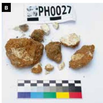
18 Základový pilíř odkrytý v archeologické sondě v podlaze kaple sv. Bartoloměje (A). Pražský hrad, vzorek PH 27 (B). Malta se jeví jako chudá na pojivo, ale vápno tvoří až několik cm velké shluky. Z odebraného vzorku je zřejmé, že vápna nebylo přidáno tak málo, jak se na první pohled zdá, ale při ledabylém promíchání během hašení s pískem se nevytvořila homogenní maltová směs.
