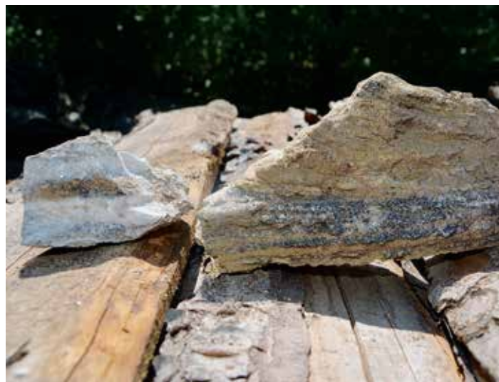
32 U nedvědeckého krystalického vápence se výpalem zviditelnily nekarbonátové příměsí, u některých došlo i k natavení a slinutí. Vpravo je vápenec po výpalu, menší bílý kámen vlevo je obdobná surovina před výpalem.
