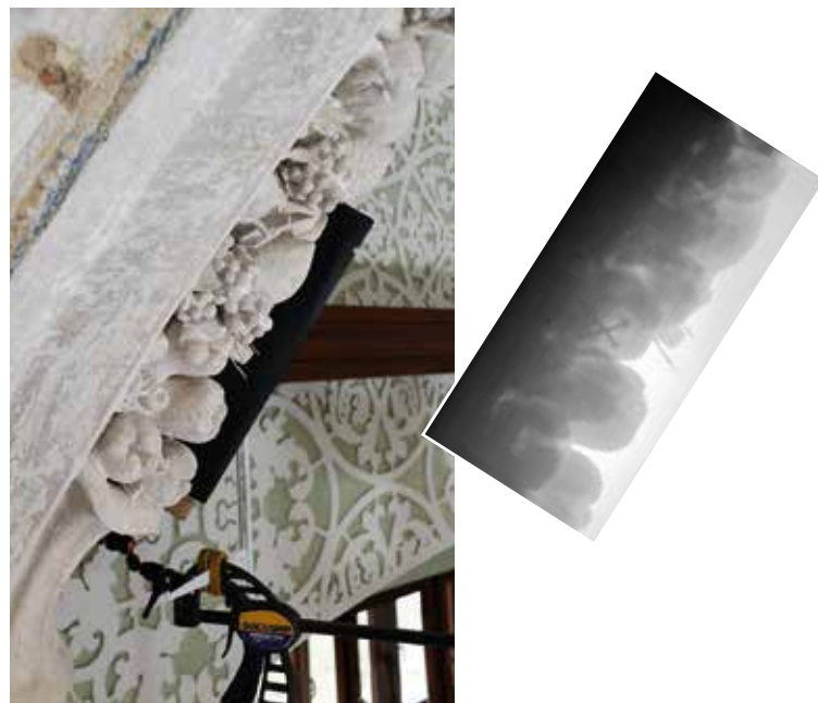
14 Místo průřezu a snímek ovocné výzdoby klenebního žebra pořízený přenosným rentgenovým přístrojem. Pomocí kovových hřebů je s podkladem spojen pouze jeden ovocný prvek. Další kovové prvky ve formě drátků jsou použity jako stopky třešní.
