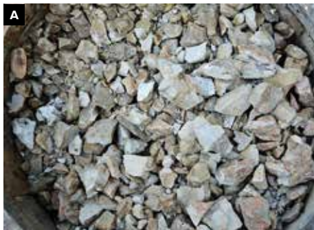
31 Dokumentace množství svrchu odebraného materiálu do hloubky asi 20 cm pod vrchem pece, který nebyl zcela vypálen (A), odebíraného vápna s tmavším nedopáleným jádrem (B) a kusu plně vypáleného vápna z klenby topeniště (C). Výpal zlíčovského vápence z r. 2016.
