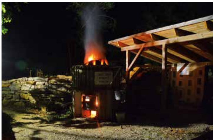
28 Roztopená pec přibližně po 20 hodinách, po přiložení prochází plamen skrz vsázku a hoří nad ní. Výpal krystalického vápence z obecního lomu v Nedvědicích z r. 2017.
