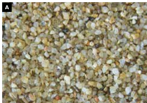
19 Vybrané frakce písku po rozpouštění vzorku malty perlovce ze štukové výzdoby na zámku Červená Lhota, vzorek SCL 15. Zrnitostní frakce 0,063–0,125 mm (A), 0,125–0,5 mm (B) a 0,5–1 mm (C).
