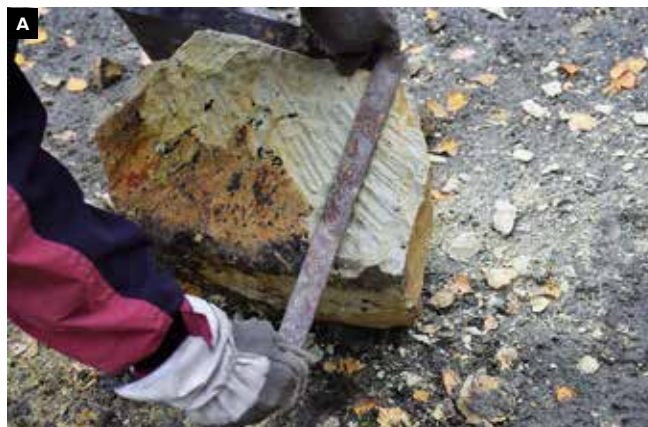
13 Hrubé opracování opuky na kvádry v lomu. Jednotlivé kameny se rozdělily na skupiny podle výšky a z předpokládané lícové strany upravily do roviny. Aby se podařilo udržet pravý úhel mezi čelem a spodní nebo horní stranou kamene, musel se použít úhelník (A). Právě natěžený kámen se formátoval ručními nástroji včetně funkčních replik vyrobených podle středověkých vzorů: plošiny s břitem a plochými zuby (B) a špicplošiny (C).
