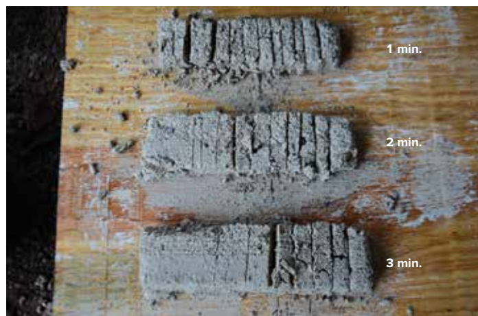
23 Fotografie ukazuje sádrové trámečky z běžné modelovací sádry a vody po zkoušce tuhnutí určeného souběžnými fezy v postupně se prodlužujících časových intervalech. Trámečky byly zhotoveny po 1, 2 a 3 minutách míchání.
