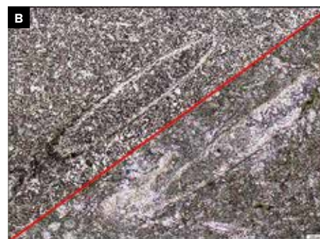
Dvorecko-prokopský vápenec, malta nalezená pod Jiřským náměstím, vzorek PHA 3, vs. vápenec z lomu Branické skály, PPL (B). Zlíčovský vápenec z románského hradebního zdiva Pražského hradu, vzorek PH 5, vs. vápenec z Prokopského údolí, PPL (C).
