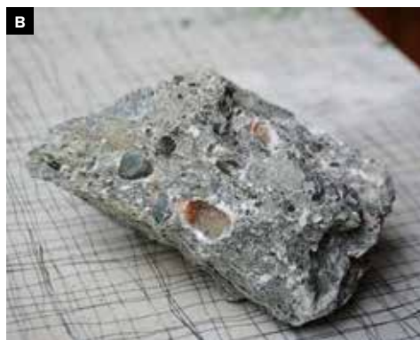
16 Krystalický vápenc Chýnov, poloha vysokoprocenní suroviny, tzv. „ředák“, před výpalem (A), sádrovec z lokality Preinsfeld (Severní vápencové Alpy, Rakousko) (B), sádrovec z lokality Kobeřice (Opavská pánev, Česká republika) (C).
