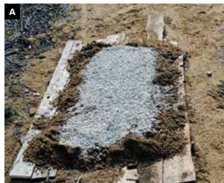
35 Hašení vápna ze zlíčovského vápence. Dokumentace vrstvení mokrého písku a vápna (A), rozpraskaná kupa vlivem hašení (B) a řez hromadou vápna a písku po několika dnech (C).
