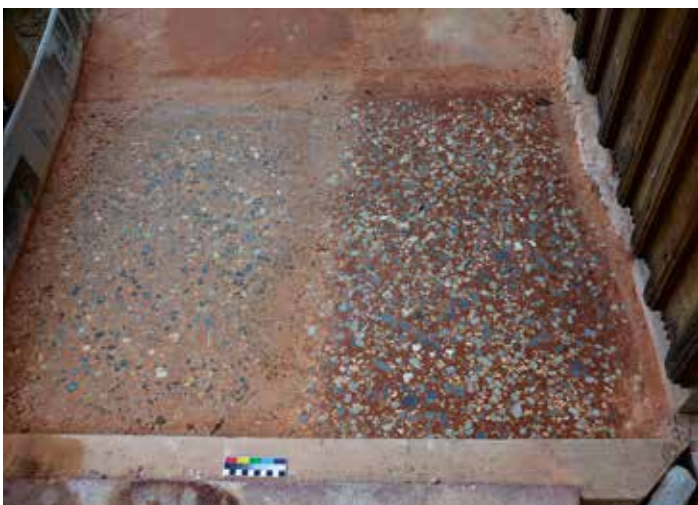
20 Povrch experimentálního panelu, benátské terrazzo. Vlevo je povrch vybroušen brusnými kameny, na pravou část byla použita elektrická bruska.
