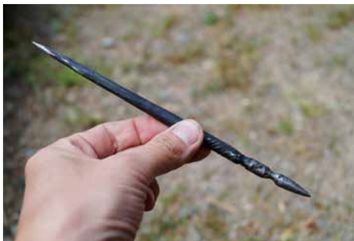
24 Rycí nástroj (graffio) – různé zkosený kuželovitý hrot. Vyrobil Robert Wacha.
