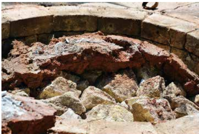
30 Dobré klimatické podmínky umožnily hladký průběh výpalu včetně „dopálení“ vsázky až po svrchní vrstvu. Na kamenech je vidět část jílové vrstvy. Výpal chýnovského vápence v r. 2018.
