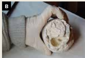
Vzorek lepicí malty LCL 1 (A) a místo odběru vzorku LCL 3 ze spodní strany štukového ovoce (B).
