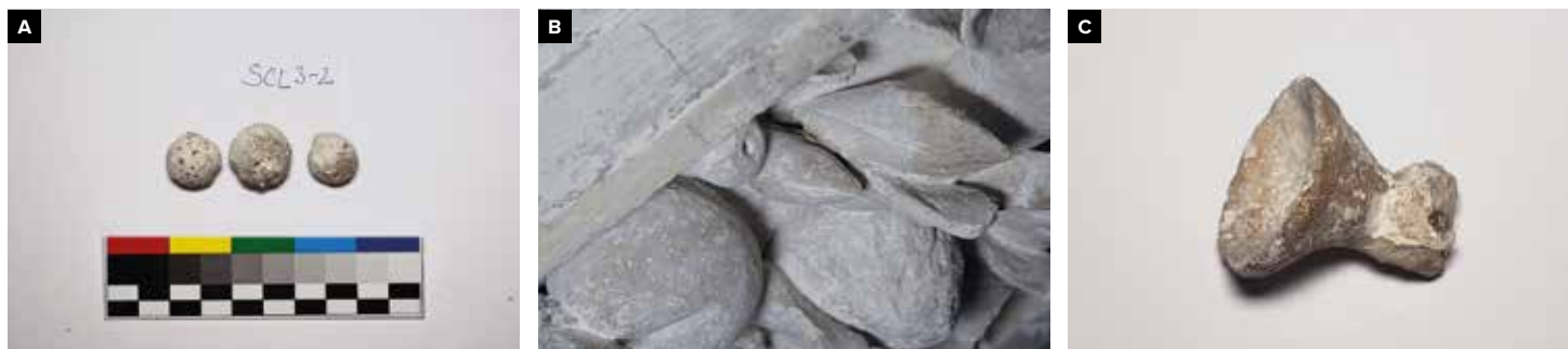
36 Výroba repliky drobných štukových doplňků zahrnuje kuličky třešní a hroznového vína (A), poupata a malé plody (B), květy, kalichy a další tvary (C).
