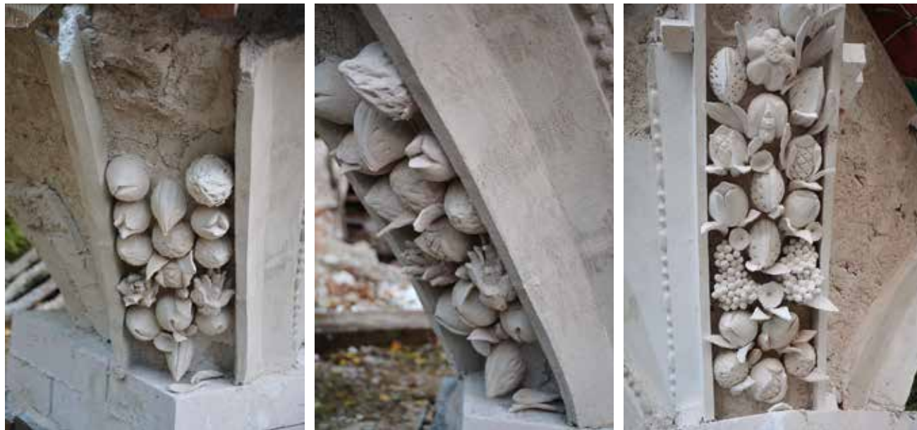
21 Model napodobující sklon a zakřivení klenebního žebra v měřítku odpovídajícím skutečnému provedení. Experimentální centrum v Solvayových lomech.
