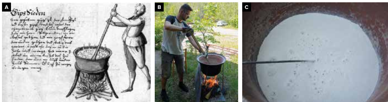
19 Výpal sádry na nízkou teplotu na dobové ilustraci (Götz et al. 2018; A), při současném experimentu (B) a detail povrchu nadrceného sádrovce, ze kterého při varu uniká voda (C).
