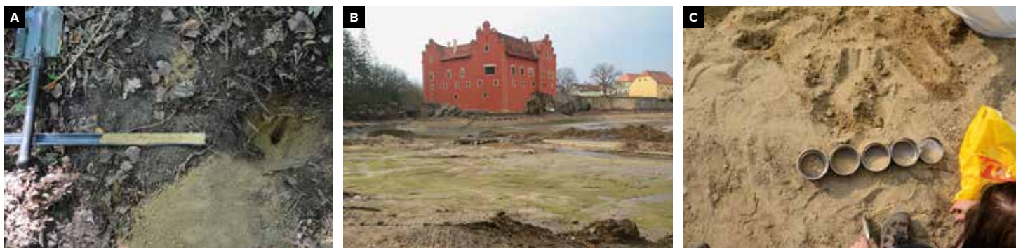
17 V blízkosti zámku se nachází více poloh písčitého materiálu, jak v okolním lese (A), tak přímo na dně místního rybníka (B), kde se již při odběru uskutečnila alespoň orientační granulometrická zkouška (C).
