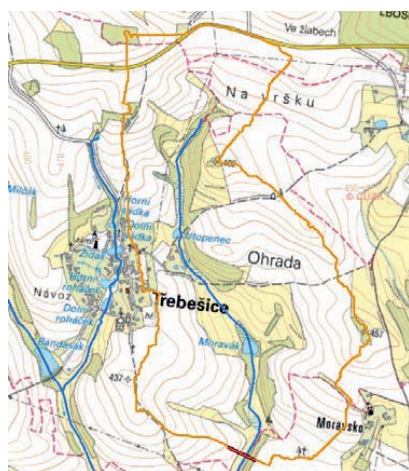
Obrázek 11: Povodí suché nádrže s vyznačeným profilem hráze.
