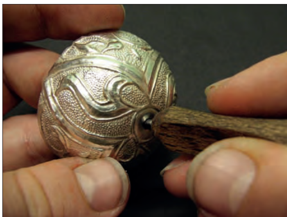
Obr. 6/165: Zhotovení otvoru do jedné z polokoulí gombíku. Fig. 6/165: Piercing the upper hemisphere.
