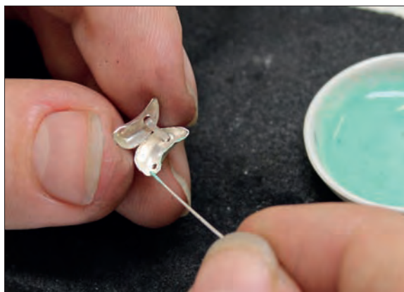
Obr. 6/245: Na styčné plochy polovin je nanесena difuzní pájka. Foto J. Sobek.
