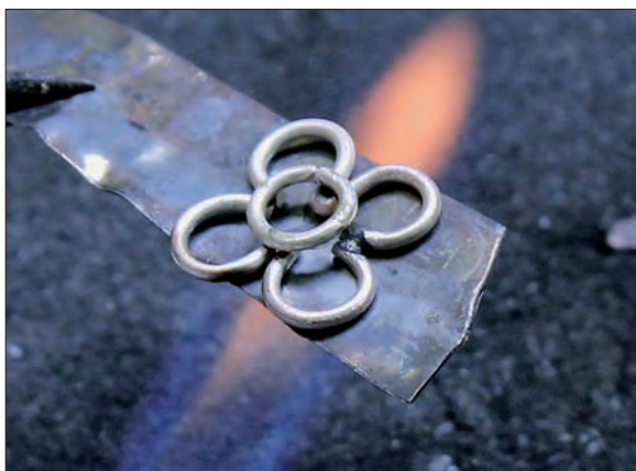
Obr. 6/111: Do středu „čtyřlístku“ je nanášena difuzní pájka, umístěn kroužek.
