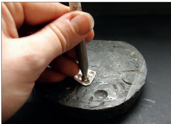
Obr. 6/190: Na formu se položí plech a pomocí ocelového čakanu a kladiva se vytepá profil náušnice. Fig. 6/190: A sheet is placed over the shaped depression and the earring's profile is hammered with a dapping punch and a hammer.
