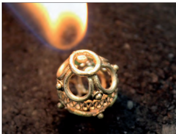
Obr. 6/118: Pájení polokoulí. Foto J. Sobek.
