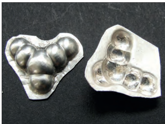
Obr. 6/192: Vytepané poloviny těla náušnice. Fig. 6/192: Hammering of half of the earring's body.
