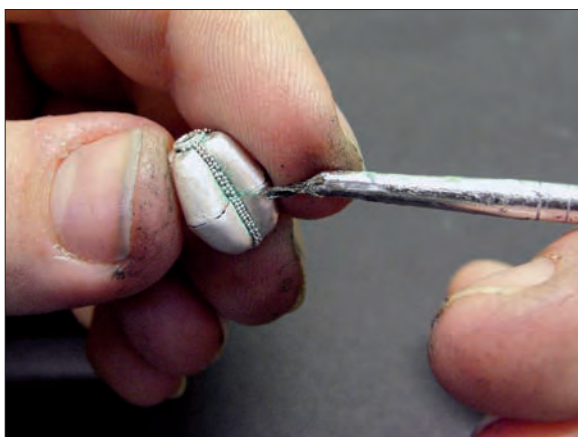
Obr. 6/96: Nanášení difuzní pájky a granulí na jednu čtvrtinu plochy perly.
