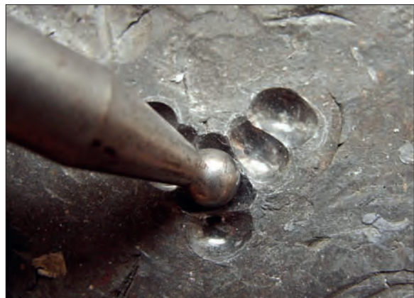
Obr. 6/189: Vytepání potřebného tvaru formy do olova pomocí ocelového čakanu. Fig. 6/189: Forming the required depression in the lead block with a dapping punch.
