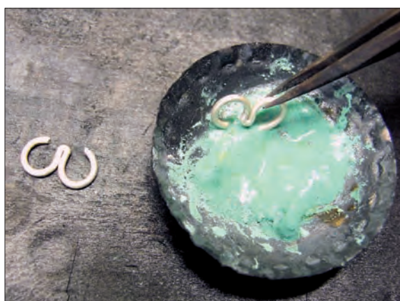
Obr. 6/108: Segment ve tvaru písmene omega je v místě pájeného spoje opatřen difuzní pájkou.
