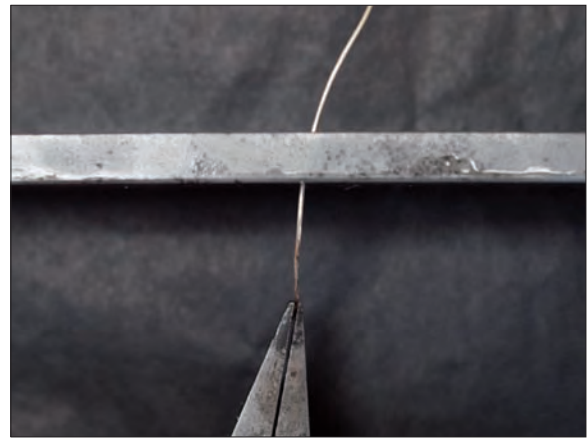
Obr. 6/21 a 6/22: Protahování drátu v průvlastku. Obr. 6/21 and 6/22: Wire drawing with a drawplate.
