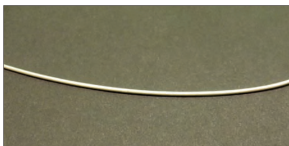
Obr. 6/35: Pohled na připravený drát po protažení na potřebný průměr.
