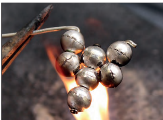
Obr. 6/229: Pohled na pájení bubínek náušnice k sobě. Foto J. Sobek.
