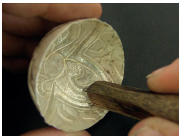
Obr. 6/162: Stínovaný dekor je nutné ještě doretušovat z vnitřní strany.
