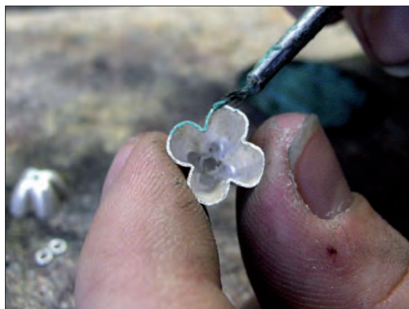
Obr. 6/93: Nanášení difuzní pájky.
