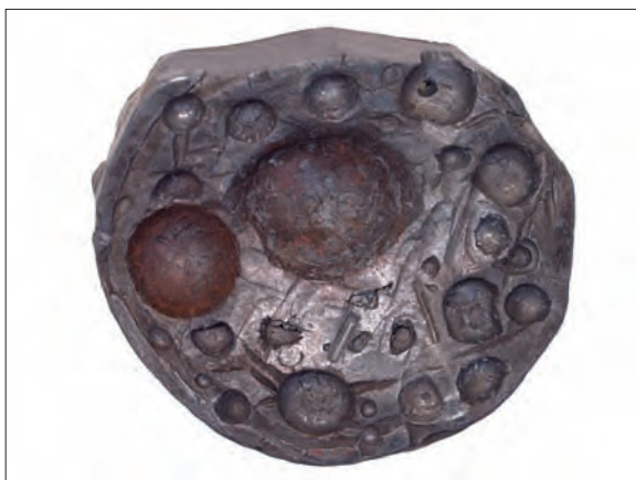
Obr. 6/15: Olovená jamkovnice s předtepanými jamkami.
