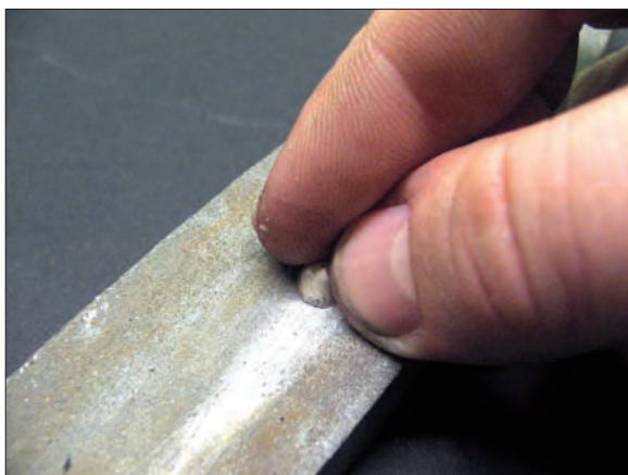
Obr. 6/129: Zabroušení nerovného povrchu puklice tak, aby správně dosedal na kulatý tvar perly a bylo možné jej připájet.
