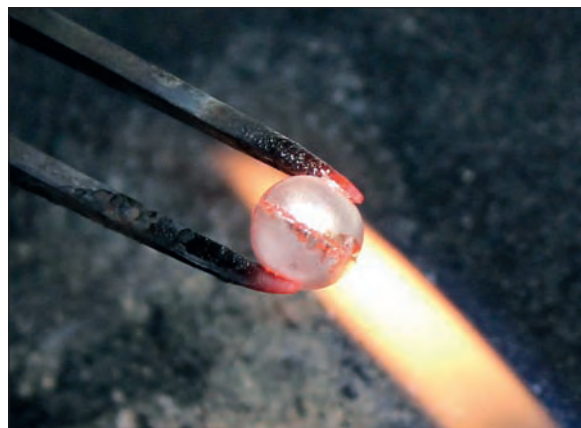
Obr. 6/212: Pájení bubínku. Foto J. Sobek.
