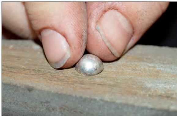
Obr. 6/67: Zabroušení polokoule na kamenném brousku. Foto E. Ottenwelter.
