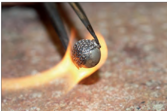
Obr. 6/72: Kroužky se na povrch perly pájely plynovým hořákem, v uzavřených prostorách je použití pece nevhodné. Foto E. Ottenwelter.
