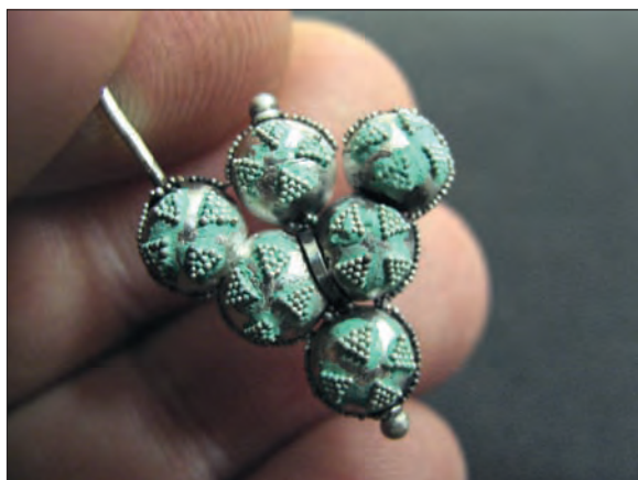
Obr. 6/223: Vyskládání a pájení dekorativní granulace.
