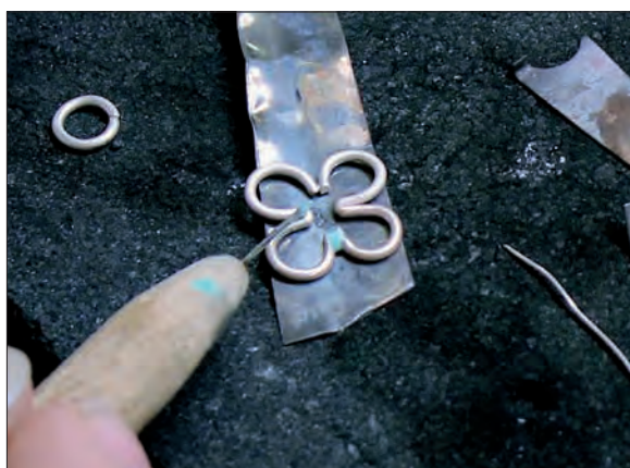
Obr. 6/109: Umístění dvou segmentů naproti sobě na tenký železný plech. Foto J. Sobek.
