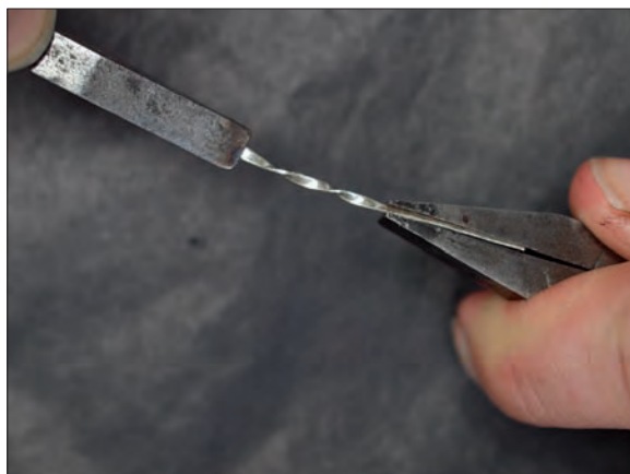
Obr. 6/28: Tordování pomocí dvou kleští. Fig. 6/28: Twisting with a pair of pliers.
