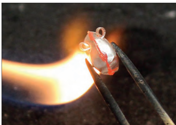
Obr. 6/246: Poloviny jsou spasovány, uchyceny do kleští a pájeny. Foto J. Sobek.
