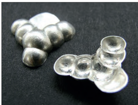
Obr. 6/195: Obě poloviny po zabroušení; na jedné polovině je vystřížen půlkruhový segment náušnice. Fig. 6/195: Both halves after grinding; a semi-circular plate was left on one of the earring's half.
