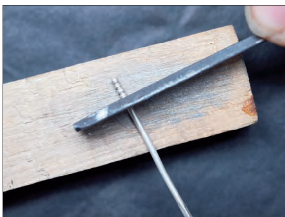
Obr. 6/30: Výroba jednotlivých kuliček perlovce. Fig. 6/30: Manufacture of beaded wire.
