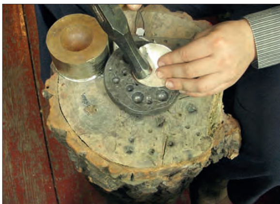
Obr. 6/151: Při práci byla jamka v olovu prohlubována tak, aby vyhovovala při tvarování plechu. Postup byl stejný, tepalo se od kraje do středu plechu.
