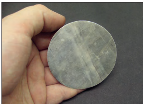
Obr. 6/149: Pohled na vystřižené kolo. Pro zhotovení jednoho gombíku bylo zapotřebí dvou kol. Fig. 6/149: Cut disc; Two discs are needed to produce a gombik .
