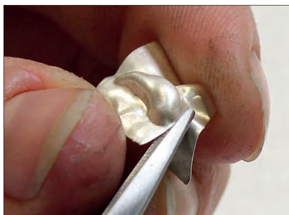
Obr. 6/241: Zastřížení přebytečného materiálu kolem profilované poloviny segmentu. Foto J. Sobek.
