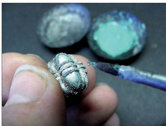
Obr. 6/100: Vyskládání malých granulí s nanášením difuzní pájky. Fig. 6/100: Attaching small granules by application of powder of malachite mixed with gum tragacanth.
