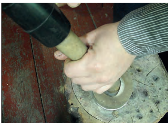
Obr. 6/153: Tepání poloviny v jamce pomocí čakanu a palice.
