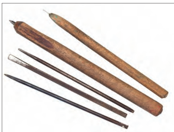
Obr. 6/6: Ocelové nástroje; ocelová jehla, čakany, hrot s tupou špičkou ve dřevěné rukojeti, jehla ve dřevěné rukojeti. Fig. 6/6: Steel tools, steel needle, punches, blunt-end tracer punch set in wooden handle, needle set in wooden handle.
