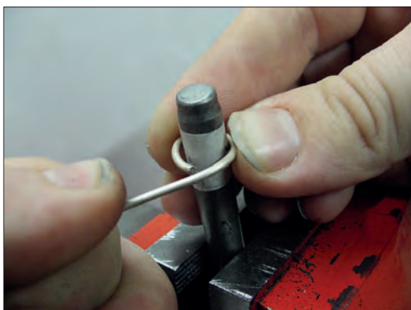
Obr. 6/167: Dalším krokem bylo zhotovení úchytu tvarováním kroužku úchytu podle kulatiny. Fig. 6/167: Next step represents forming of the loop by shaping a ring around a round mandrel.
