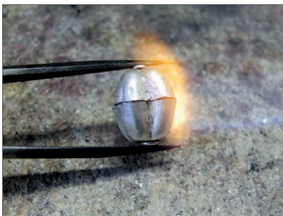
Obr. 6/94: Poloviny a kroužky se pájí najednou.
