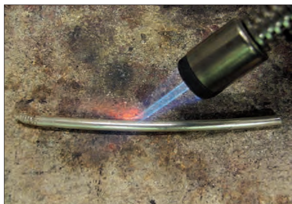
Obr. 6/50: Žihání drátu, kterým je docílena rekrytalizace materiálu po tváření; materiál je po vyžihání měkčí a je možné jej opět tvářet.
