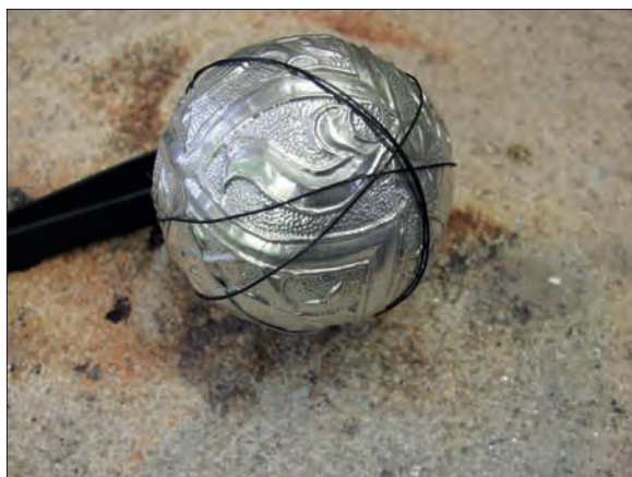
Obr. 6/166: Pájení polovin gombíku. Fig. 6/166: Soldering of both halves of the gombik .
