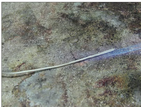
Obr. 6/39: Žihání se dělá před tvářením záušnice, materiál se potom velmi snadno tváří.
