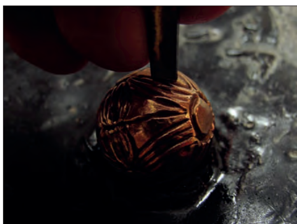
Obr. 6/179: Tepání gombíku pomocí čakanu a kladiva, celý gombík byl ještě přitmělen na tmelovou podložku.
