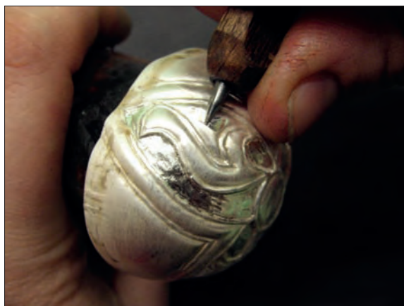
Obr. 6/160: Stínování ploch mezi geometrickým ornamentem gombíku.
