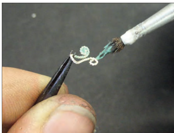
Obr. 6/138: Nanesení difuzní pájky na filigránový drát.
