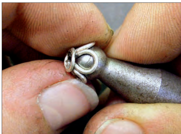
Obr. 6/112: Tvarováním na čakanu vznikne polovina perly.
