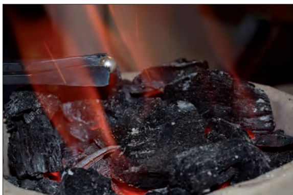
Obr. 6/70: Pájení perly v peci na dřevěné uhlí. Foto E. Ottenwelter.
