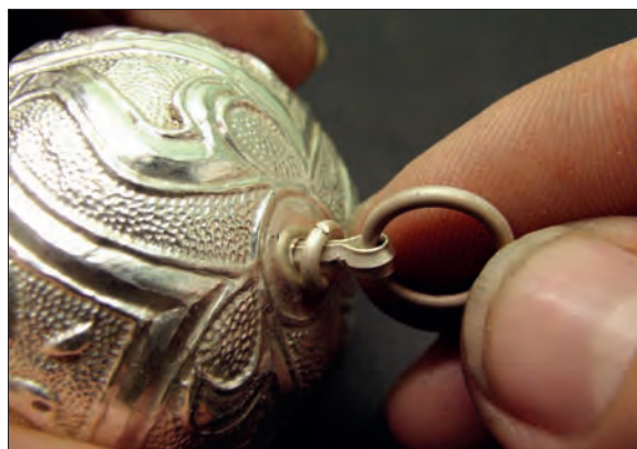
Obr. 6/170: Úchyt byl umístěn do otvoru s difuzní pájkou a pájen. Fig. 6/170: The clamp is placed in the perforation on the upper hemisphere and soldered to it.
