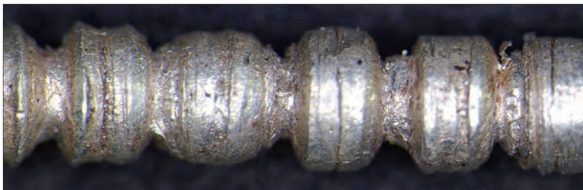
Obr. 6/32: Pohled na perlovcový drát.
