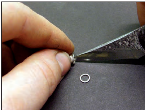
Obr. 6/25: Rozdělení jednotlivých kroužků pomocí nože. Fig. 6/25: Separation of individual circles with a knife.
