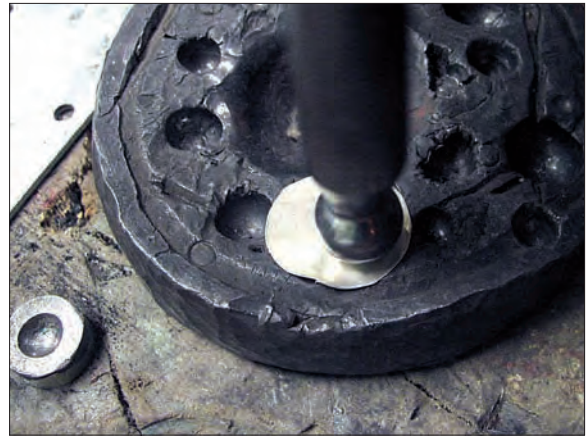
Obr. 6/81: Předtepání čakanem na olovené jamkovnici, před tvarováním polokoule v profilované jamkovnici. Fig. 6/81: The disc blank is placed over the semi circular depressions formed in the lead block with a dapping punch. The disc is hammered till it touches the bottom of the depression.
