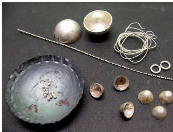
Obr. 6/130: Pohled na polotovary potřebné ke kompletaci šperku; profilované půlkoule, puklice, kroužky, filigránové dráty a granule.
