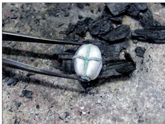
Obr. 6/97: Pájení granulí na perlu. Pájení lze dělat po čtvrtinách povrchu, aby granule nespádaly.
