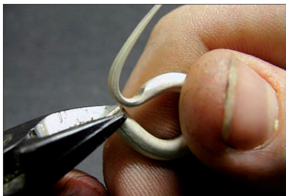
Obr. 6/55: Zaštípnutí konce záušnice.
