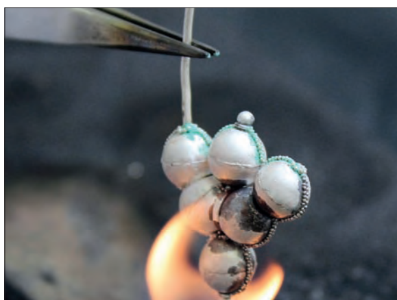
Obr. 6/222: Pájení výzdoby granulace. Foto J. Sobek.
