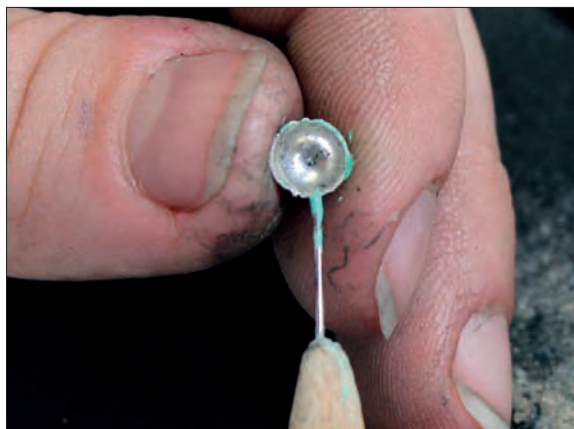
Obr. 6/211: Nanášení difuzní pájky na hranu polokoule s následným spasováním s druhou polovinou. Foto J. Sobek.
