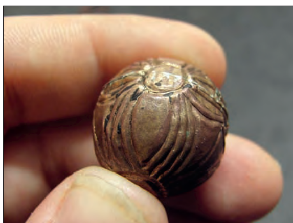
Obr. 6/180: Detail po tepání plochým čakanem.
