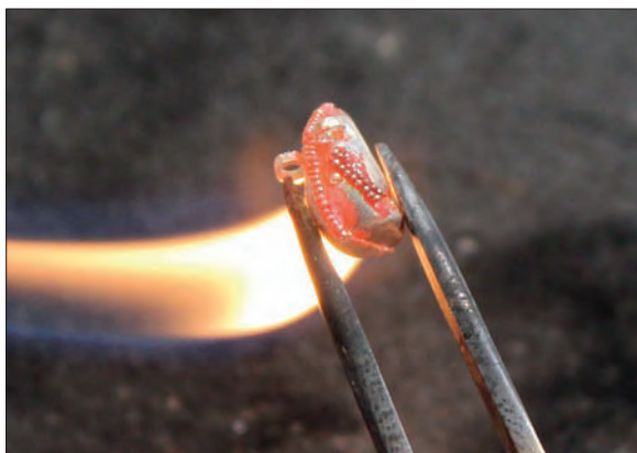
Obr.6/ 248: Pájení boční řady granulí na bubínku. Foto J. Sobek.
