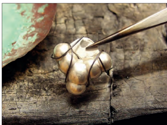
Obr. 6/196: Na místa spoje je nanese difuzní pájka, poloviny jsou k sobě fixovány drátem. Následuje jejich pájení. Fig. 6/196: The diffusive solder is applied on the joint and both halves are fixed together with a wire. Both halves are then soldered together.
