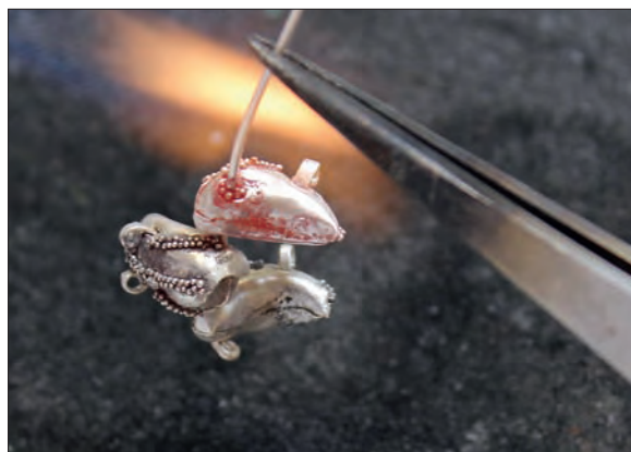
Obr. 6/251: Pájení malých granulí, které fixují bubínky. Foto J. Sobek.
