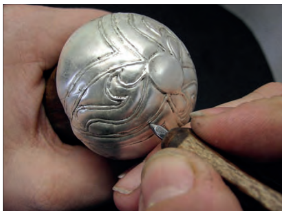
Obr. 6/159: Po natmelení na tmelku byly linky zdvojeny.
