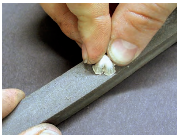
Obr. 6/89: Následné zabroušení nerovného povrchu tak, aby obě poloviny na sebe správně dosedaly.
