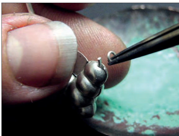
Obr. 6/200: Kolem otvorů v těle náušnice jsou umístěny kroužky s přidáním difuzní pájky. Fig. 6/200: Small rings are placed around openings in the earring's body by application of powder of malachite mixed with tragacanth.
