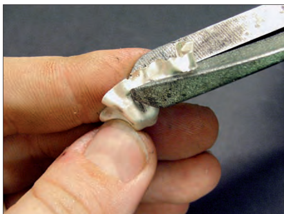
Obr. 6/88: Zastřížení přebývajícího plechu poloviny.
