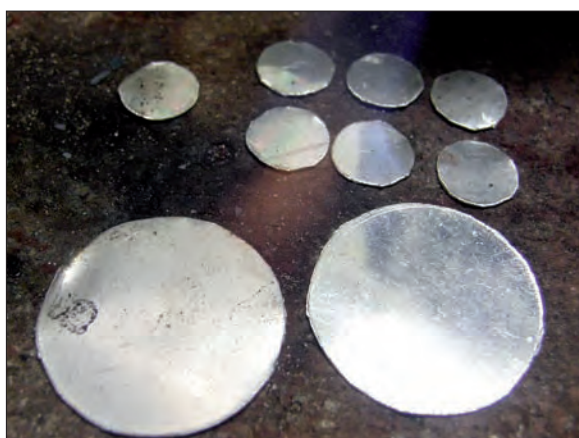
Obr. 6/125: Žihání materiálu před tvářením. Fig. 6/125: Annealing of the material before its shaping.
