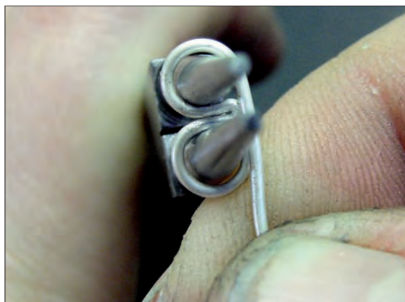
Obr. 6/106: Tvarování drátu v kleštích.
