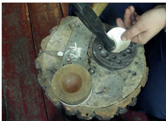
Obr. 6/150: Tepání poloviny gombíku se dělalo pozvolna od kraje plechu do středu na olověné podložce s předtapanou mělkou jamkou. Fig. 6/150: The disc blanks are placed over the depression formed in the lead block and are hammered down to force the disc into the depression from the disc's edge to its centre.
