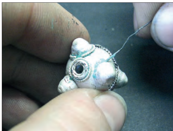
Obr. 6/136: Umístění filigránového drátu na perlu s nanesením difuzní pájky.
