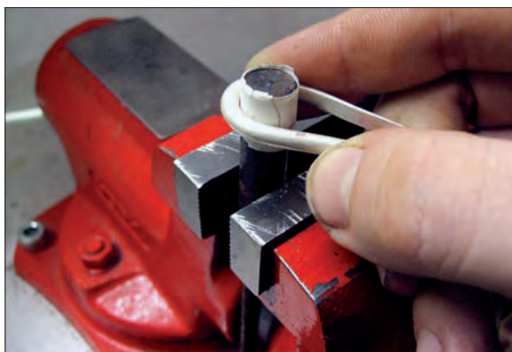
Obr. 6/54: Tvarování záušnice na kulatině potřebného průměru.
