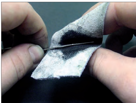
Obr. 6/40: Leštění záušnice pomocí jemné kůže s nardrceným dřevěným uhlím.
