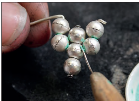
Obr. 6/228: Nanášení difuzní pájky do prostoru spoje jednotlivých bubínek. Foto J. Sobek.
