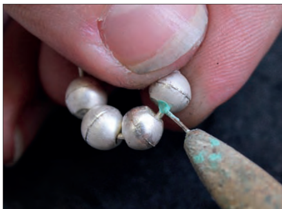
Obr. 6/215: Nanášení difuzní pájky do prostoru spoje jednotlivých bubínků. Foto J. Sobek.
