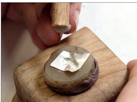
Obr. 6/240: Vytepání profilované části jedné poloviny segmentu ze stříbrného plechu. Foto J. Sobek.
