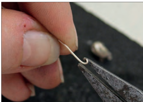
Obr. 6/249: Drát náušnice je na konci vytvarován do háčku, který po navléknutí na drát zafixuje bubínky před připájením. Foto J. Sobek.
