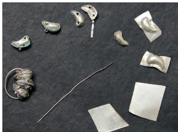
Obr. 6/239: Postup výroby náušnice od plechu po náušnici. Foto J. Sobek.
