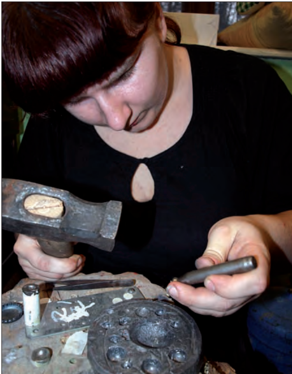
Obr. 6/63: Pohled při práci s olověnou jamkovnicí. Foto E. Ottenwelter.
