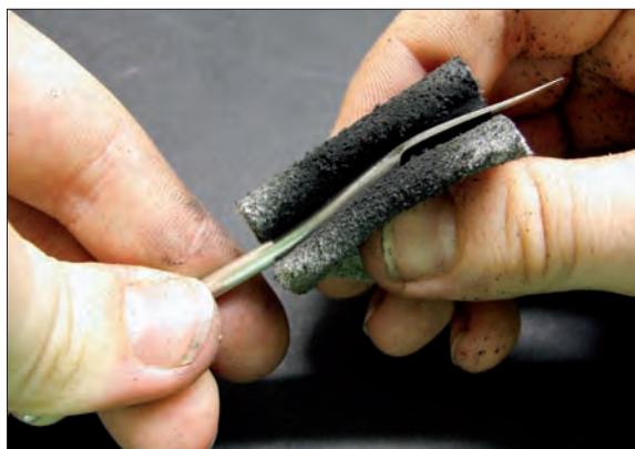
Obr. 6/53: Předleštění záušnice před tvarováním.
