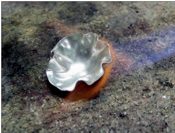
Obr. 6/82: Opětovné žihání plechu po tváření v jamkovnici. Fig. 6/82: Annealing of the disc after its shaping on the lead block.
