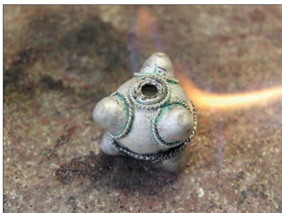
Obr. 6/137: Pájení filigránu na tělo perly.
