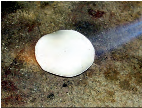
Obr. 6/80: Žihání materiálu před tvářením. Fig. 6/80: Annealing of the material prior shaping.
