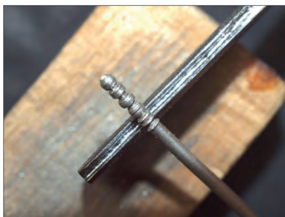
Obr. 6/31: Detail pracovní plochy přípravku se stříbrným drátem s vytlačeným perlovcem. Fig. 6/31: A double-edged tool is used to produce beading.
