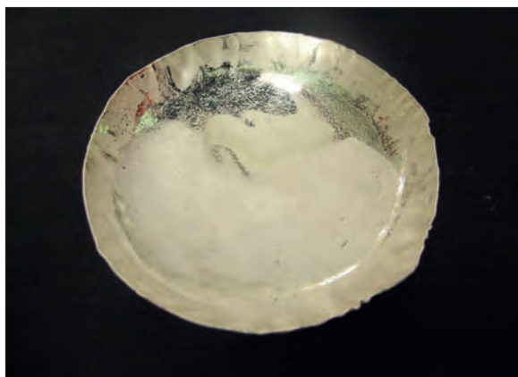
Obr. 6/152: Pohled na polovinu gombíku při tepání.
