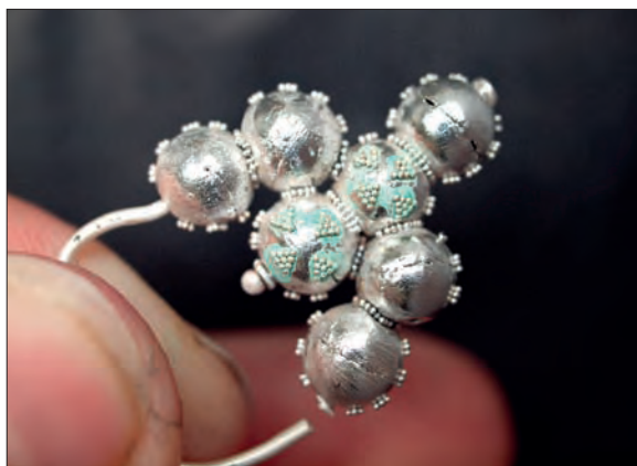
Obr. 6/233: Postupné vyskládání granulace na jednu stranu náušnice. Fig. 6/233: Gradual setting of granules on one side of the earring.
