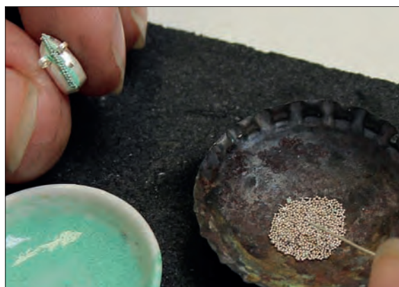
Obr. 6/247: Na místa pájeného spoje na pohledové vrchní části jsou nanесeny drobné granule ve dvou řadách a přidána difuzní pájka. Foto J. Sobek
