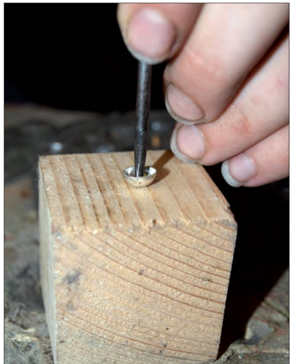
Obr. 6/66: Detail vyrážení otvoru pomocí ocelové jehly. Foto E. Ottenwelter.
