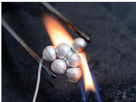
Obr. 6/220: Následuje pájení bubínek k náušnici. Foto J. Sobek.
