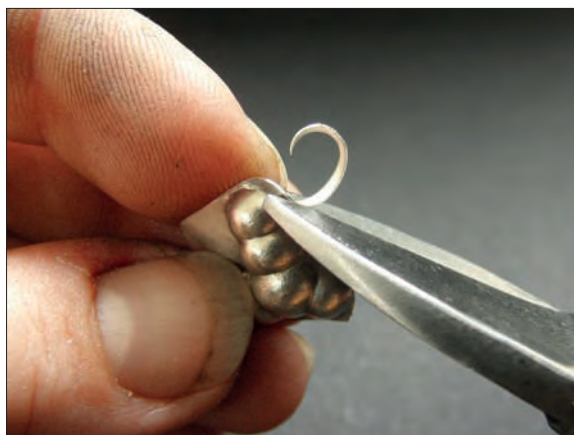
Obr. 6/193: Přesahy plechu je možné odstříhnout nůžkami nebo odseknout sekáčem na tvrdší podložce. Fig. 6/193: Excess sheet is cut away with scissors or chop off with a chisel on a hard pad.
