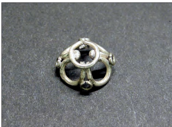
Obr. 6/113: Na polovinu byly opět s difuzní pájkou připájeny malé kroužky.
