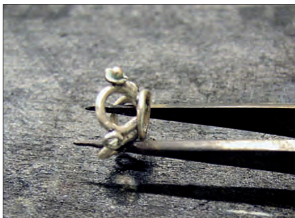
Obr. 6/114: Do kroužků byly umístěny granule a pak následovalo pájení s difuzní pájkou.
