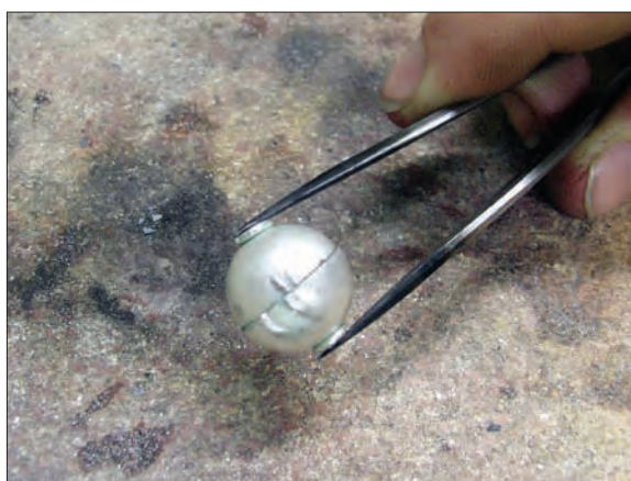
Obr. 6/132: Pájení polovin a kroužků najednou.
