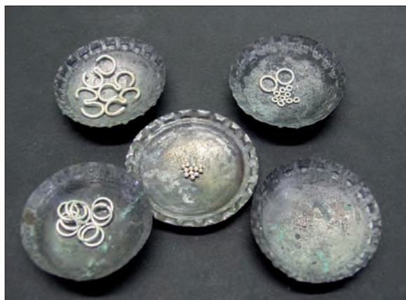
Obr. 6/105: Připravené polotovary pro výrobu perly; kroužky, granule a segmenty drátu ve tvaru písmene omega ( \omega ).
