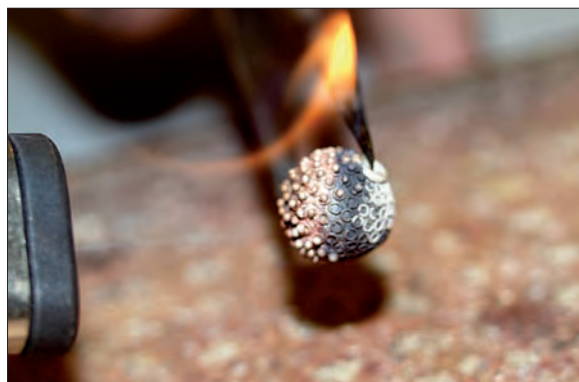
Obr. 6/76: Pájení granulí na povrch perly. Foto E. Ottenwelter.
