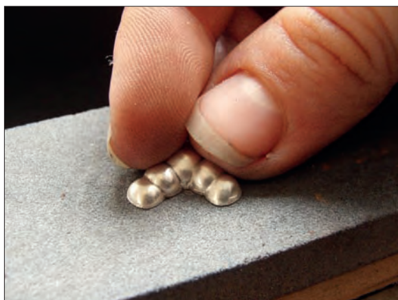
Obr. 6/194: Zabroušení poloviny těla náušnice. Fig. 6/194: Grinding of half of the earring's body.
