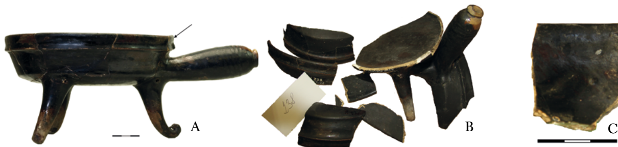
Obr. 126: A – snímek analyzované pánve 238/C po rekonzervačním zásahu; B – střepevý materiál daného předmětu; C – analyzovaný střepe. VŠCHT Praha.
