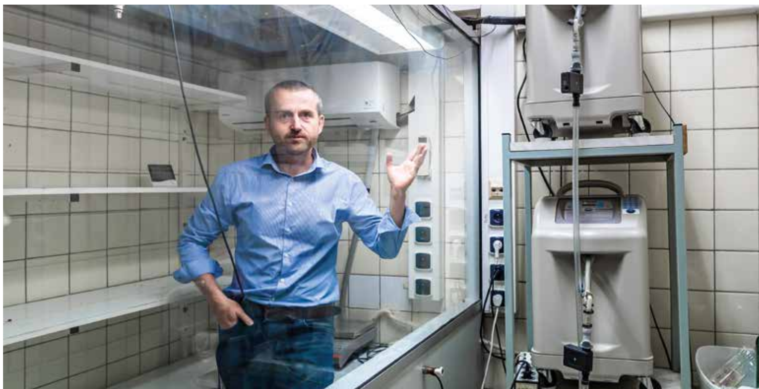
„V normobarické hypoxické komoře adaptujeme laboratorní zvířata na hypoxické podmínky díky generátorům produkujícím vzduch odušený o kyslík,“ říká Jan Neckář.
