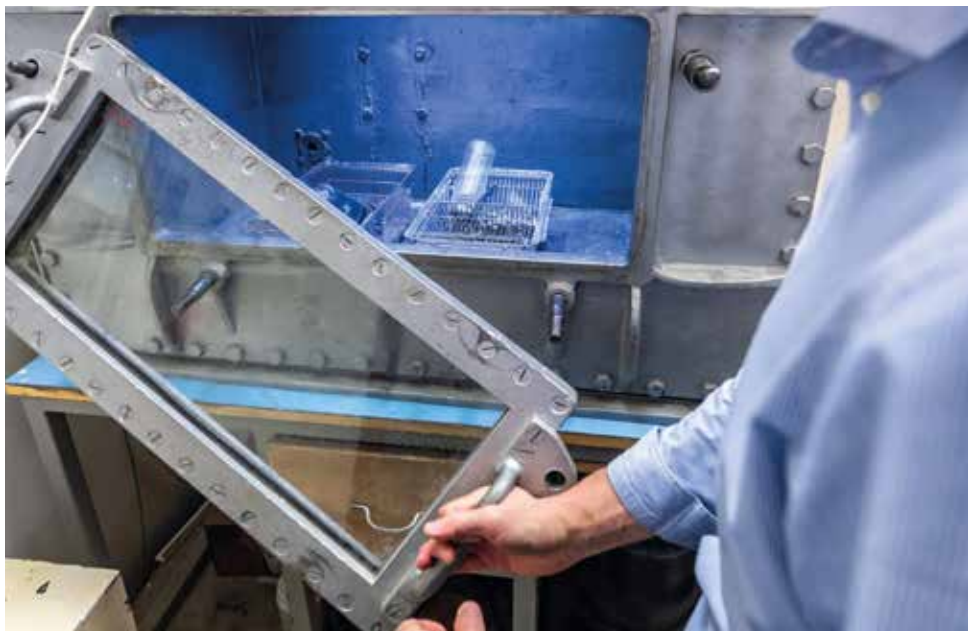
Pohled dovnitř hypoxické komory. V zařízení pro laboratorní zvířata vědci simulují vysokohorské prostředí a následně zkoumají jeho vliv na organismus.
