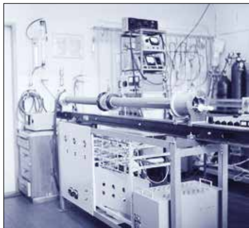
Obr. 3 CO 2 laser o výkonu 200 W pojmenovaný Barnabáš (60. léta XX. století)
