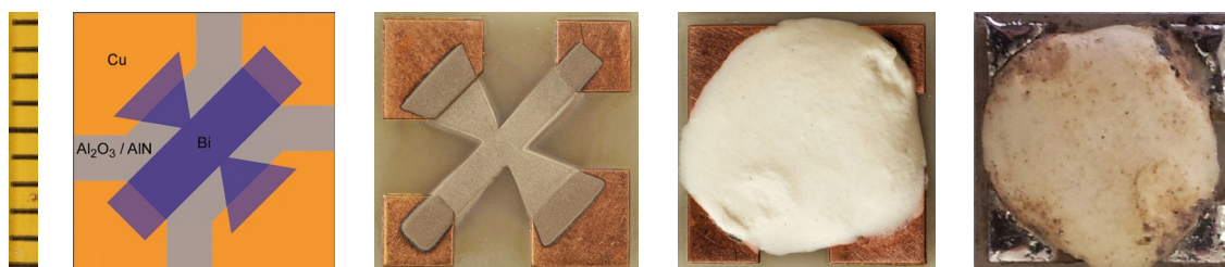
Obr. 6 První série bismutových senzorů 9,6 \times 9,6 \text{ mm} . Zprava: návrh senzoru, senzor s bismutovou detekční vrstvou, senzor s ochrannou keramickou vrstvou a senzor po ozáření v jaderném reaktoru.
