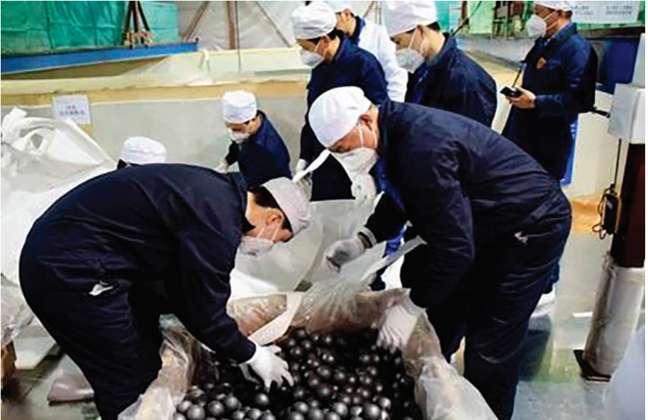
Obr. 7 Příprava kulového paliva pro čínský malý modulární vysokoteplotní reaktor HTR-PM chlazený plynem (zdroj: CNI23)
