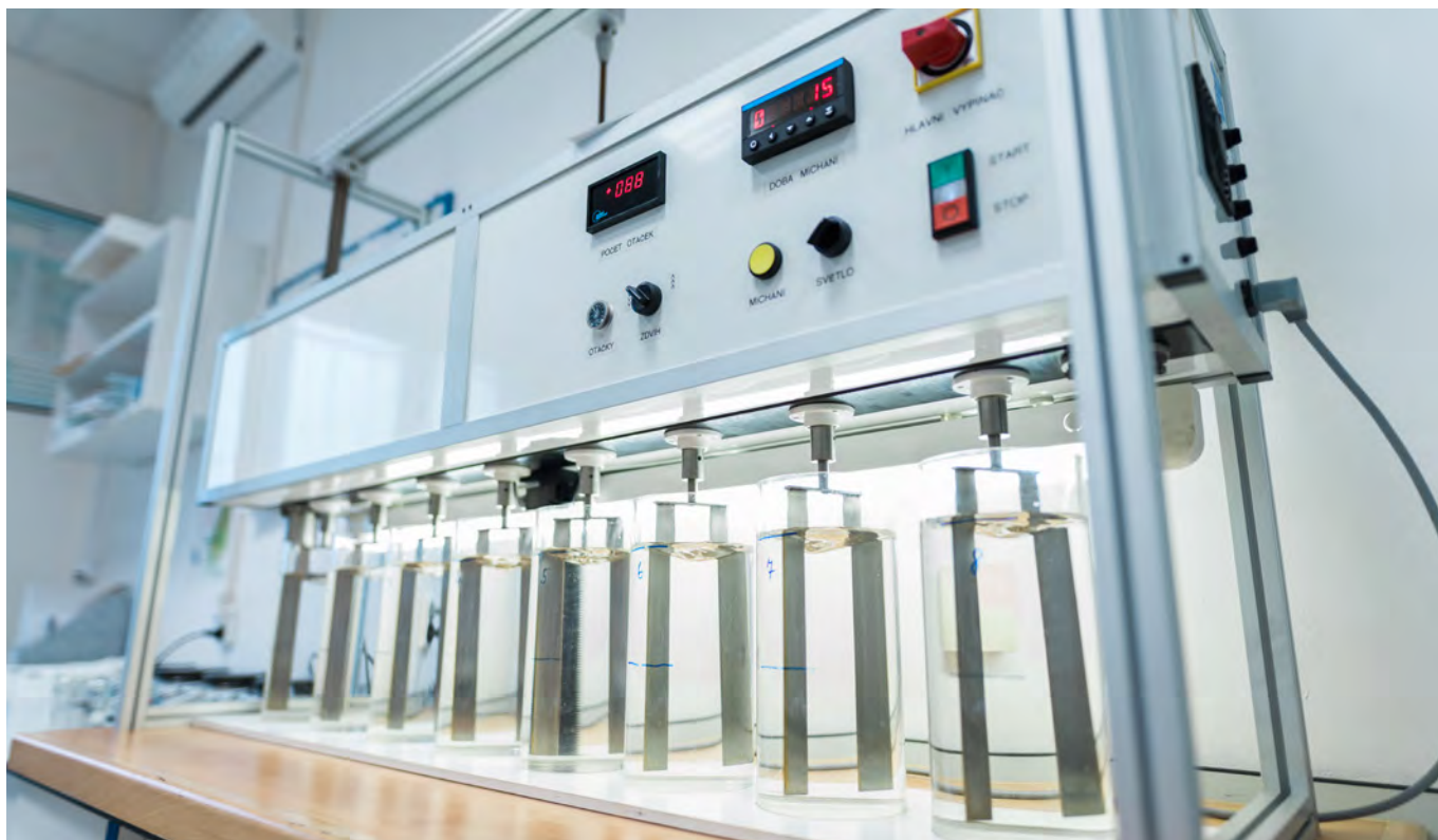
Laboratorní míchací jednotka, vyvinutá v Ústavu pro hydrodynamiku AV ČR, slouží k výzkumu koagulace/flokulace při úpravě vody.
