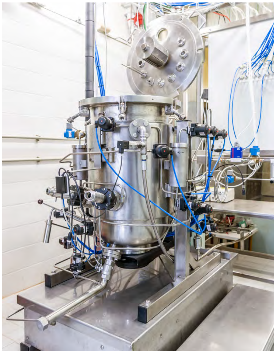
Nový typ bioreaktoru má zajistit optimální prostředí pro pěstování mikrořas s vysokým obsahem omega-3 mastných kyselin.
