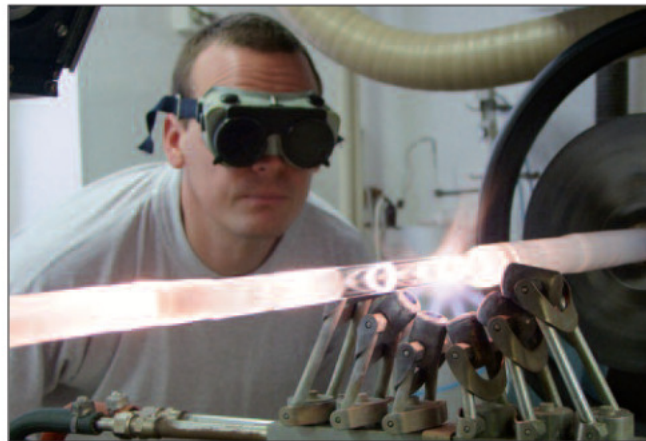
Obr. 4 Příprava preformy optického vlákna na sklářském soustruhu s kyslíko-vodíkovým hořákem v laboratoři technologie optických vláken ÚFE
