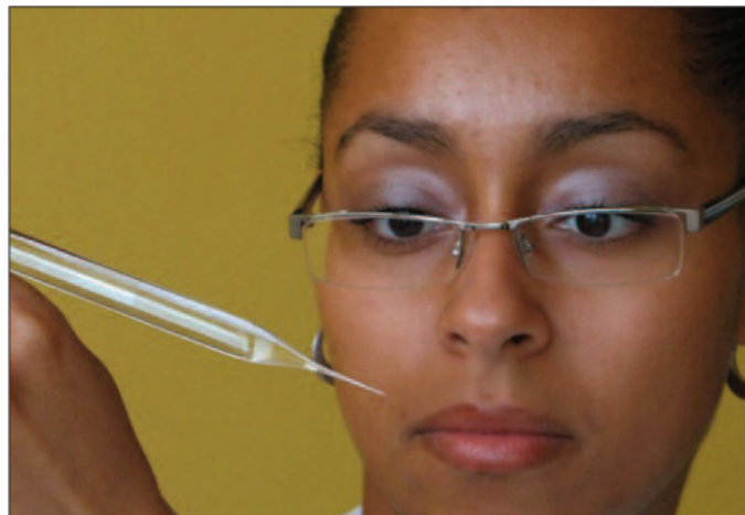
Obr. 6 Kónický přechod z preformy na vlákno vzniklý v grafitové peci tažící věže z obr 5
