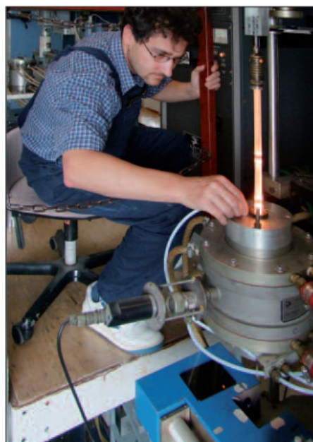
Obr. 5 Preforma optického vlákna zasunutá do grafitové pece v nejhořejší části jedné ze dvou tažících věží pro přípravu experimentálních optických vláken v ÚFE
