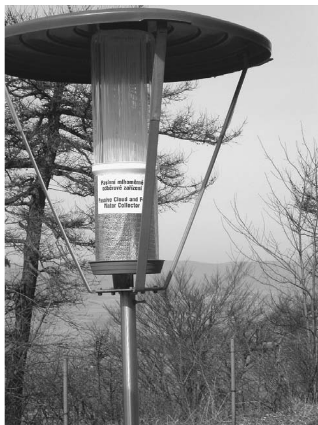
Obr. 3. Pasivní zařízení pro odběr vody z námraz.
