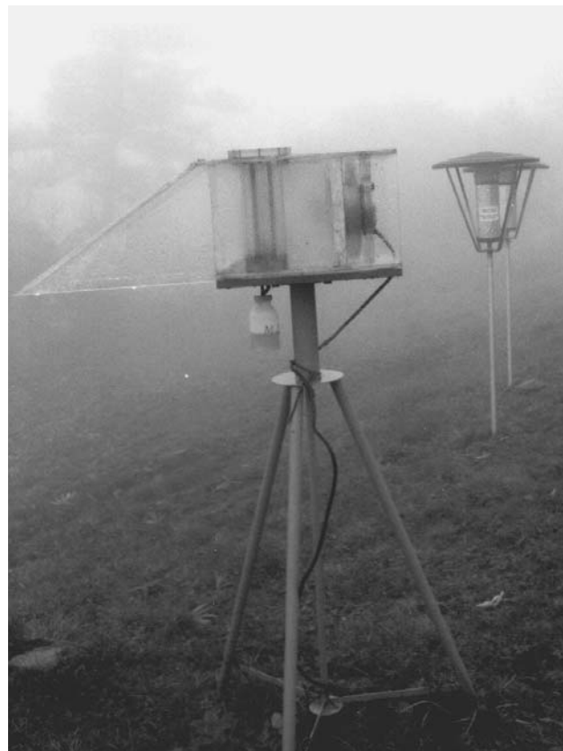
Obr. 2. Aktivní zařízení pro odběr vody z mlh.
