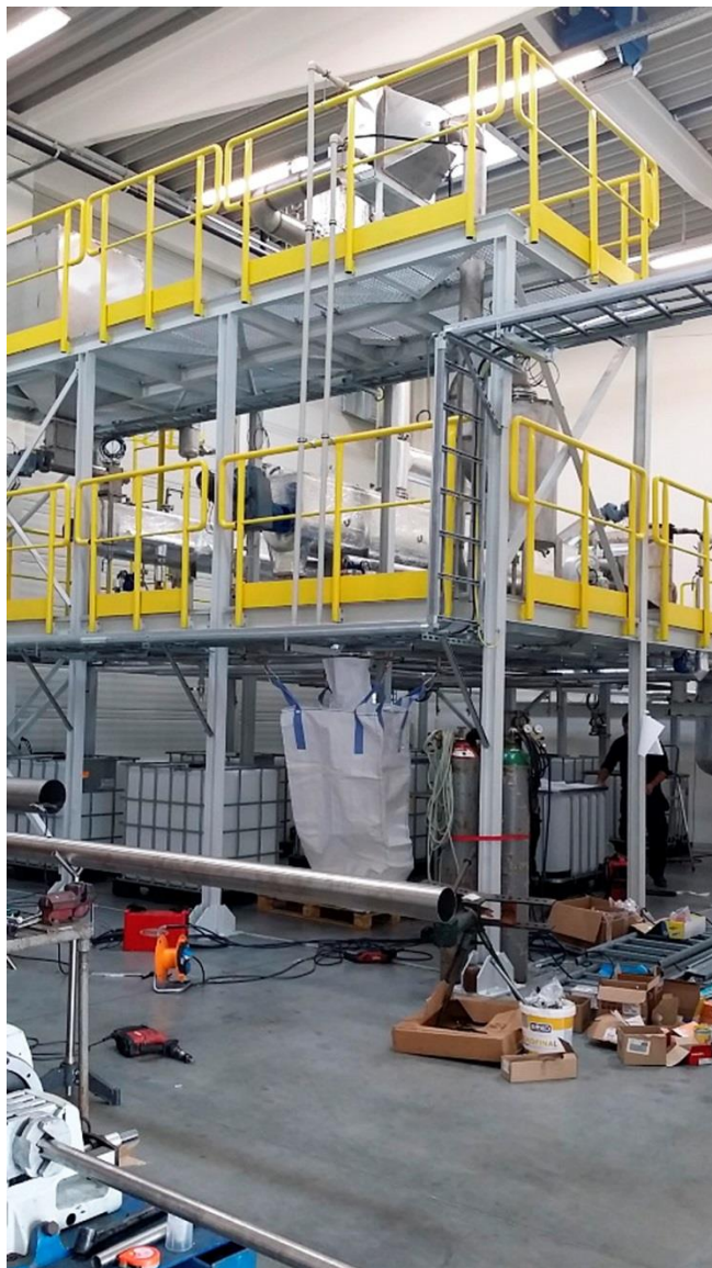
Zařízení pro rozduřování obalových kompozitních materiálů s poloprovozní linkou o kapacitě 300 kg / h
