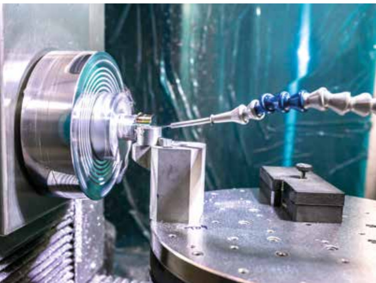
Obráběcí zařízení pracuje s přesností až tři nanometry. Proces může trvat několik desítek minut či hodin.
