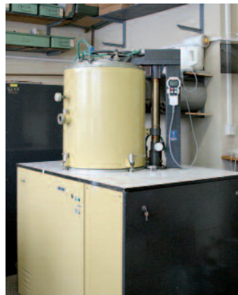
Modernizovaná vakuová pec PZ 810.
