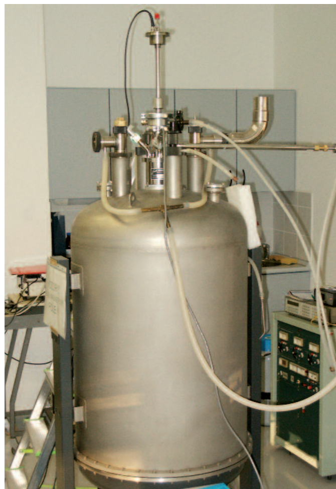
Kryostat supravodivého magnetu spektrometru NMR.
