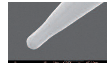
Katoda – detail hrotu (obrázek z REM).
