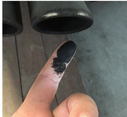
Obrázek 11: Zkouška funkčnosti DPF, zdroj: ASEM
