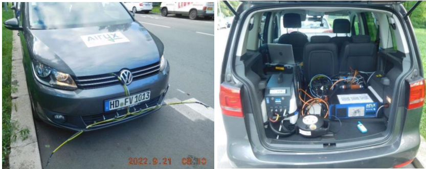
Obrázek 14: Měřící vůz Airyx při měření v Praze v rámci evropského projektu CARES
