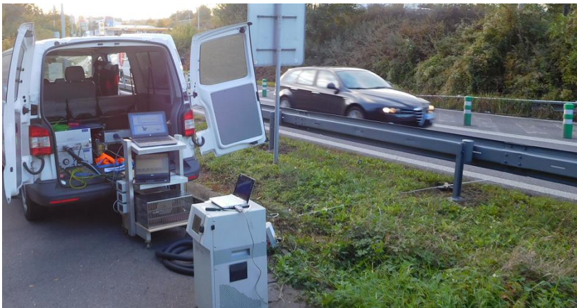
Obrázek 17: Aparatura pro dálkové měření emisí s odběrem vzorku z okraje jízdní dráhy vozidla, zdroj: http://www.nanoparticles.ch/archive/2018_Vojtisek_PR.pdf
