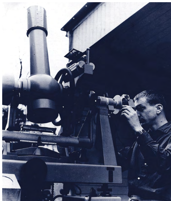
Obr. 1 Pozorování pasážíkem Zeiss 100/1000 na GO Pecny, 1963.
