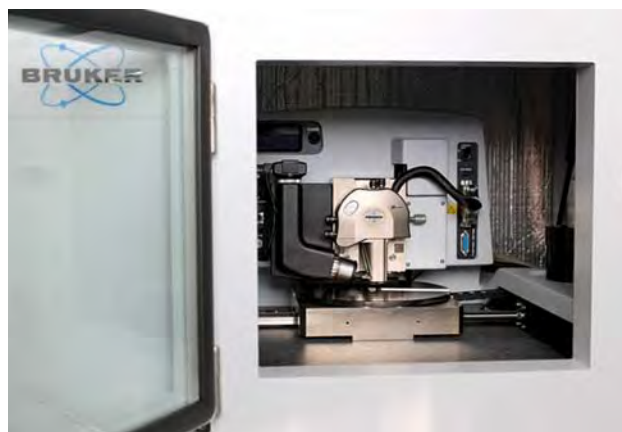
■ Obr. 14 AMF ICON od společnosti Bruker: detailní snímek měřicí hlavy umístěné v antivibrační skříni.
