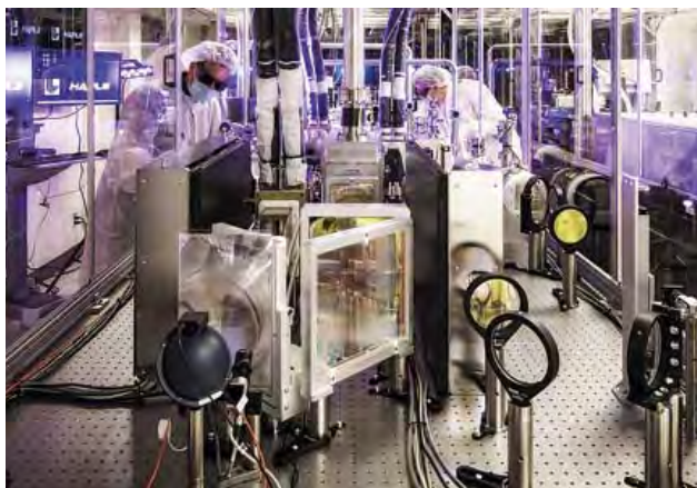
■ Obr. 13 Čerpací laser systému L3-HAPLS při testování v Lawrence Livermore National Laboratory. Výkonová část čerpacího laseru, zachycená na snímku v popředí, sestává ze dvou multideskových heliem chlazených zesilovačů. Zesilovače jsou buzeny čtyřmi bloky laserových diod poskytujících celkový impulsní výkon 3,2 MW.
