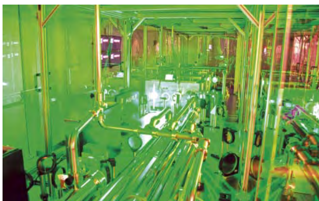
■ Obr. 14 Testovací laboratoř laserového systému L3-HAPLS v LLNL během provozu čerpacího laseru. Po konverzi základní vlnové délky 1053 nm v krystalech 2. harmonické frekvence poskytuje laser svazek na vlnové délce 527 nm. Rozptýlené záblesky zeleného světla osvětlují testovací laboratoř.
