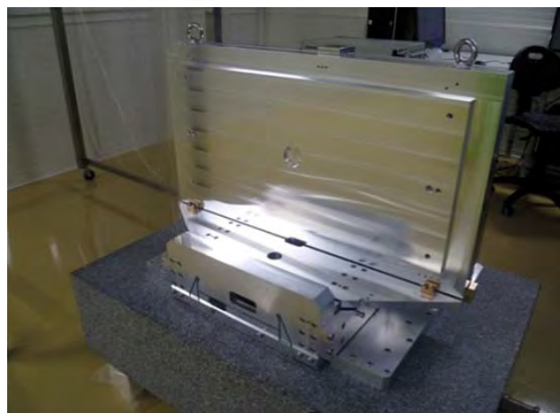
■ Obr. 15 Navržený kompresor PW pulsů systému L3-HAPLS (nahore) a prototyp ultrapřesné polohovací jednotky difrakční mřížky (dole). Vakuová jednotka kompresoru má délku přesahující 5 m.
