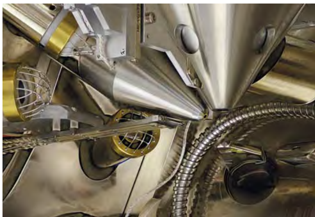
■ Obr. 13 Pohled do komory elektronového mikroskopu Fera 3. Přístroj FIB+SEM v laboratoři elektronové mikroskopie.
