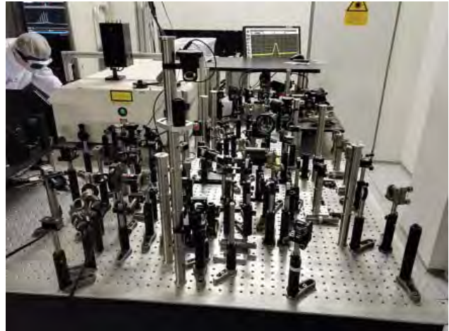
■ Obr. 11 Vývojový systém generátoru ultra širokopásmového koherentního laserového zdroje, tzv. White Light, v laboratoři FZÚ Sofia. Generátor je vyvíjen pro přídavný (sondovací) svazek systému L2 na vlnové délce 2,2 \mu\text{m} .
