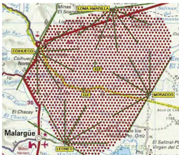
Hlavní pole observatoře Pierra Augera. Každá tečka odpovídá jedné z 1660 stanic povrchového detektoru. Čtyři fluorescenční detektory jsou umístěny na okrajích. Obrázek zahrnuje zhruba uprostřed pole také umístění dvou laserových stanic CLF a XLF.
