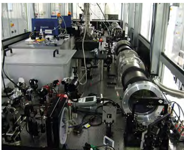
■ Obr. 7 Výkonová část 10 J / 10 Hz laserového systému pro řetězec L2, testovaný v laboratoři FZÚ Sofia. Systém využívá kryogenní multideskový zesilovač vyvinutý STFC Rutherford Appleton Laboratory (Velká Británie), zbytek systému včetně oscilátoru, čela laserového řetězce a kryogenní chladicí jednotky (teplota cca 150 K) byl navržen a vybudován pracovníky oddělení 91.
