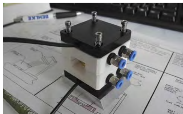
■ Obr. 3 Držák Pockelsovy cely vyvinutý pro systém PERLA C.
