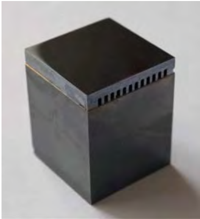
■ Obr. 5 Vzorek simulující pájený monochromátor s chladičími kanálky. Pracovní povrch musí být prakticky bez deformací.
