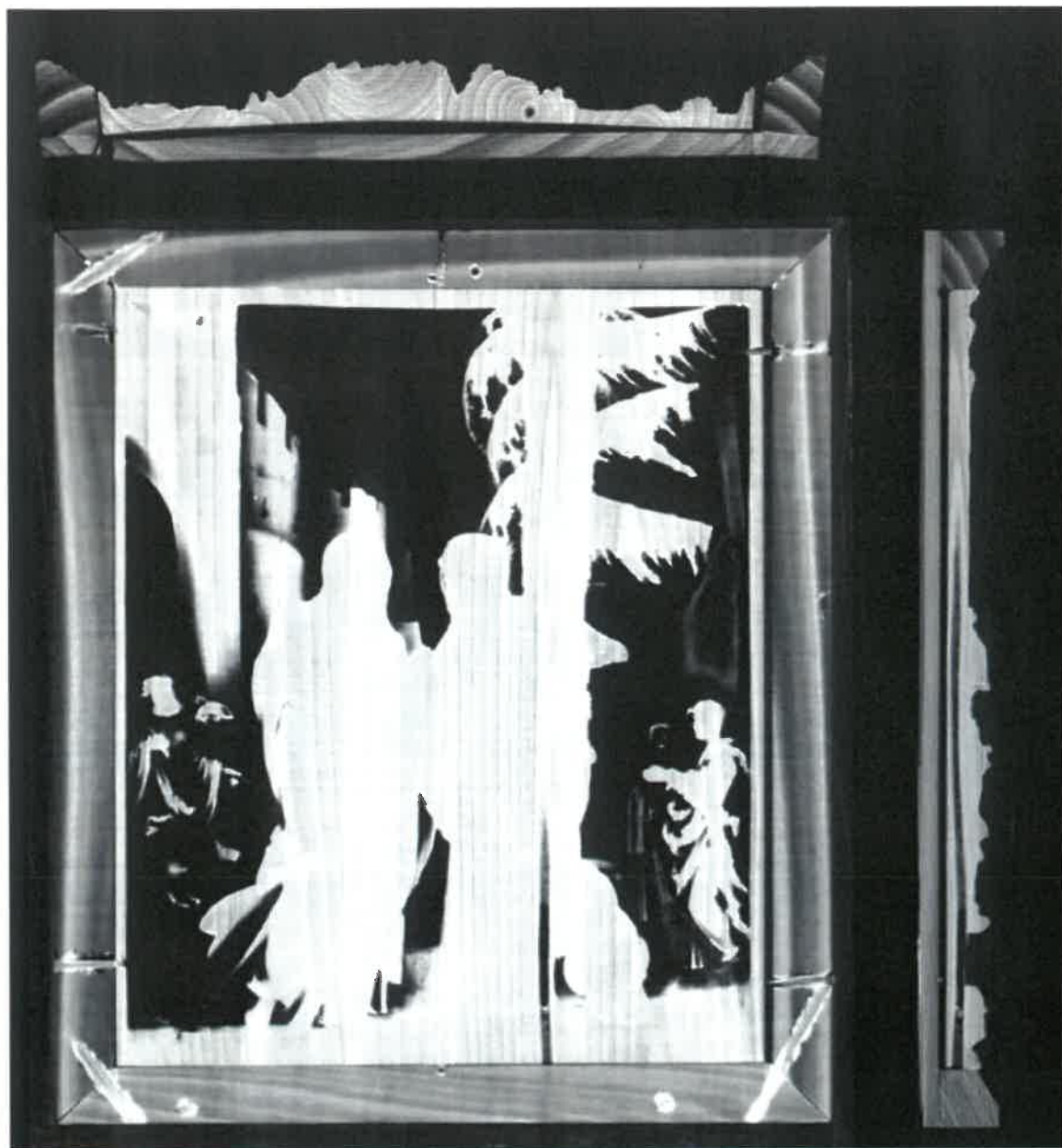
Mikro-CT snímky reliéfu Visitation. Horizontální a vertikální řezy, řez v rovině reliéfu s viditelným defektem dřeva, upevňovací prvky a rozdíl ve vzorech dřeva.
