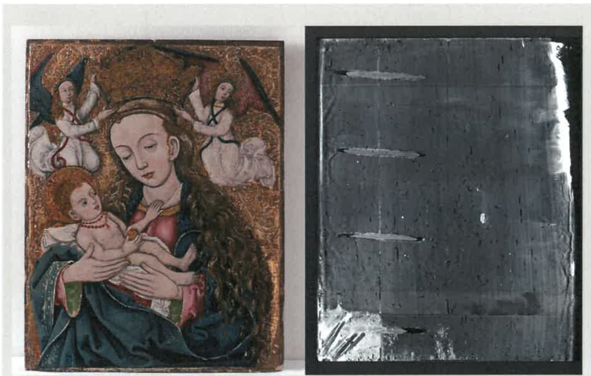
Obraz korunované Panny Marie s Ježíškem z muzea v Telči – přední strana desky (vlevo) a frontální řez deskou ze zadního pohledu, CT model (vpravo). © CET ÚTAM AV ČR, v. v. i.; Muzeum Vysočiny Jihlava, pobočka Telč. Přední strana desky s malbou Madony a Ježíška ukazuje současnou podobu malby po zásazích. Vizualizace CT modelu řezu deskou ze zadního pohledu ukazuje spoje mezi díly podkladu a výraznou druhotnou správkou spodního rohu desky.
