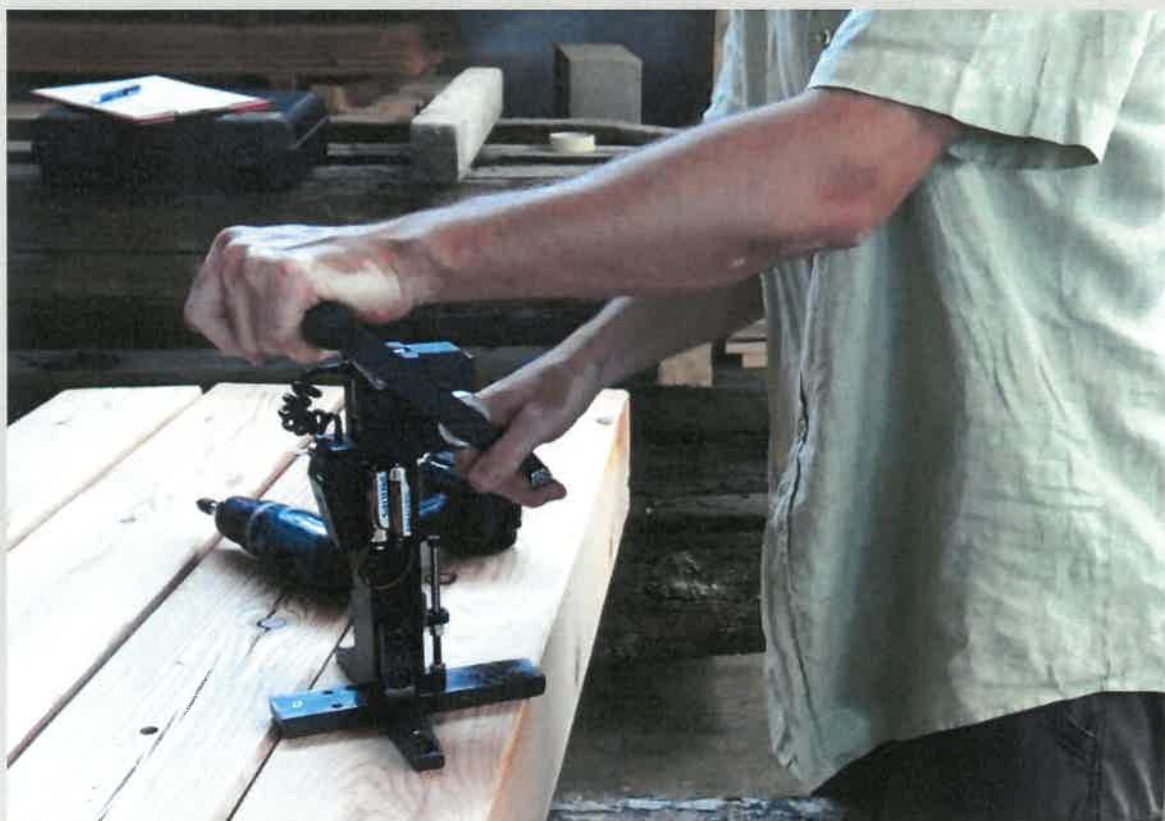
Zkouška protlačováním trnu. Příklad vyvinutý v ÚTAM mechanicky protlačuje ocelový trn dřevěným prvkem při měření odporu, který dřevo klade pohybu trnu.
