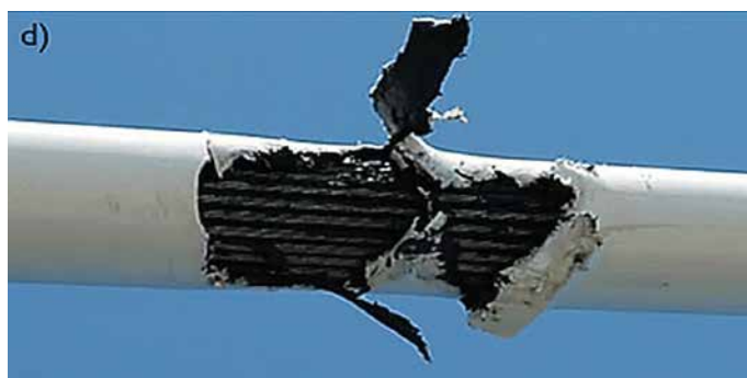
Obr. 1: Příklad námrazy a poškození lana od aeroelastického kmitání.
