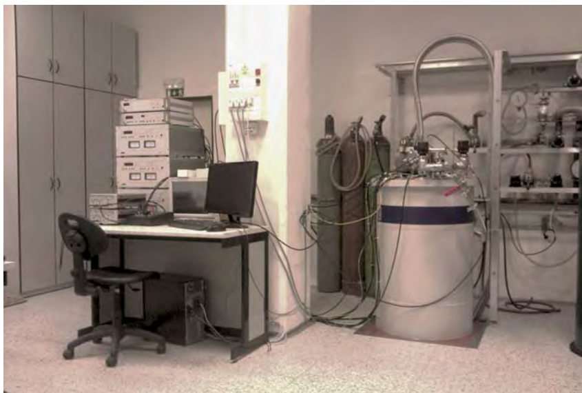
■ Obr. 4 Pohled na rekondenzační kryostat s vektorovým magnetem pro měření magnetotransportních anizotropií.
