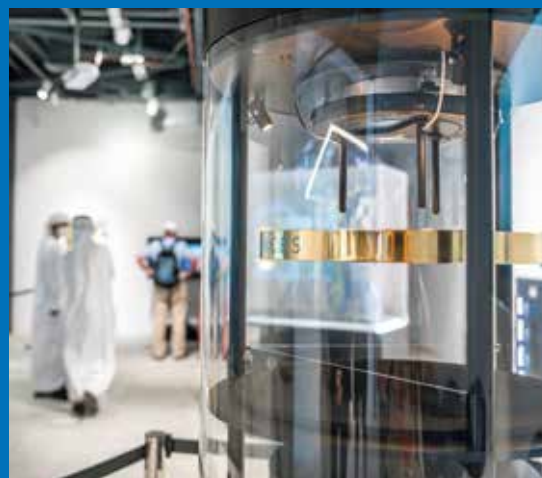
Exponát levitující pozlacené mince demonstruje nový typ magnetického závěsu setrvačnicku pro ukládání energie.
