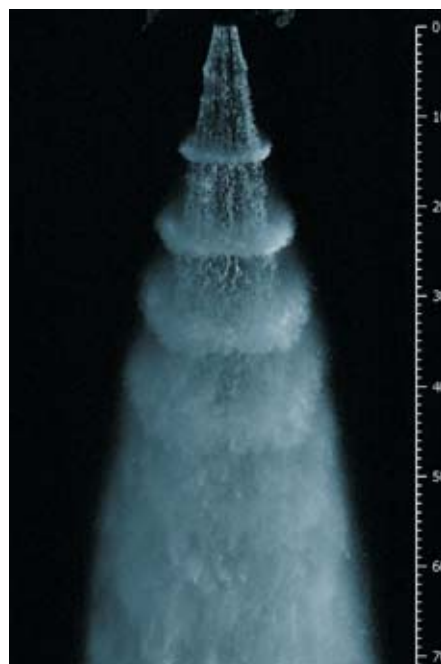
Pulzující plochý vodní paprsek generovaný tlakem 20 MPa. Měřítko udává vzdálenost od trysky v mm. (foto: archiv ÚGN)
