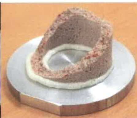
Charakteristické porušení trubkového maltového tělesa šikmou smykovou trhlinou v důsledku torzního namáhání.
