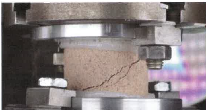
Charakteristické porušení trubkového maltového tělesa šikmou smykovou trhlinou v důsledku torzního namáhání.
