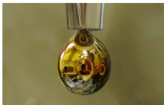
Kapka slitiny sodíku a draslíku vystavená působení vodní páry 10–4 mbar. Na kapce se usadila vrstvička vody, v níž se rozpustily elektrony uvolňované z kovu, čímž získala zlatý kovový lesk. (Foto: Phil Mason / ÚOCHB)
