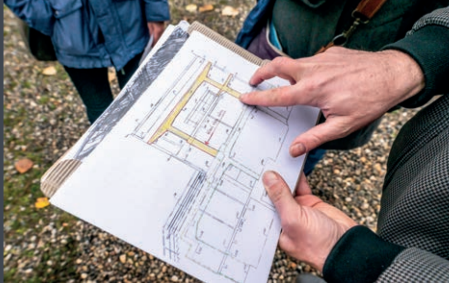
Nosným systémem budovy je železobetonový skelet, ukazuje na plánu architekt Ondřej Dušek. Stavba není v tak špatném stavu a mělo by být možné ji opravit.
