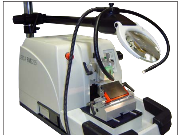
Obr. 71, Rotační mikrotom Leica s instalovaným doplňkovým vybavením: lupou a světlovodem tvořeným optickými vlákny
