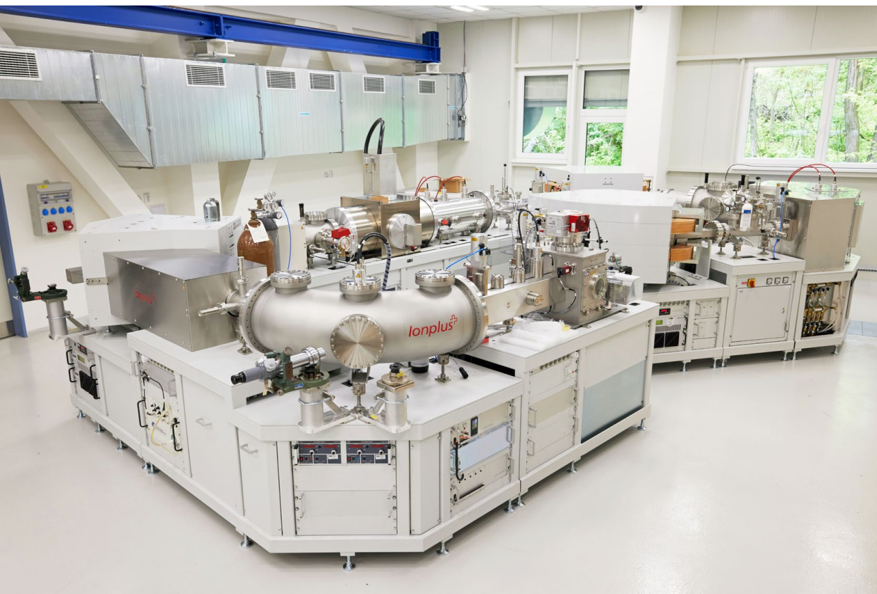
Obr. 2: Urychlovačový hmotnostní spektrometr MILEA po instalaci v Řeži
