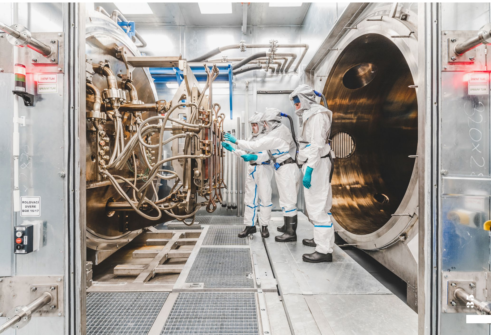
Obr. 1: Pohled na otevřenou vakuovou nádobu zařízení HELCZA - v levé části je systém na uchycení testovaného panelu
