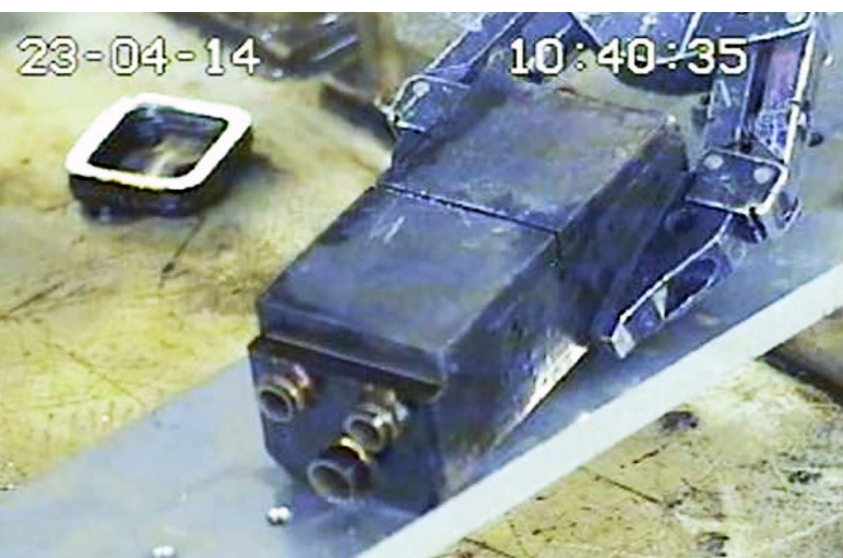
Obr. 6: Vzorek první stěny ze sondy TW3 v horkých komorách po otestování (foto CVŘ) |
