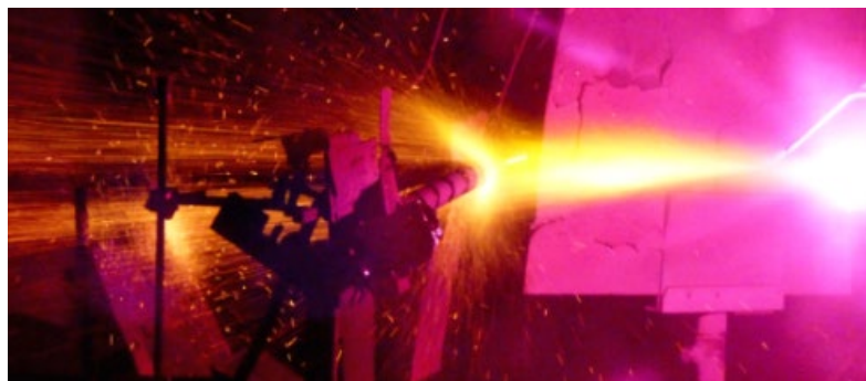
Obr. 4: Plazmové stříkání pomocí vodou stabilizovaného plazmového hořáku
