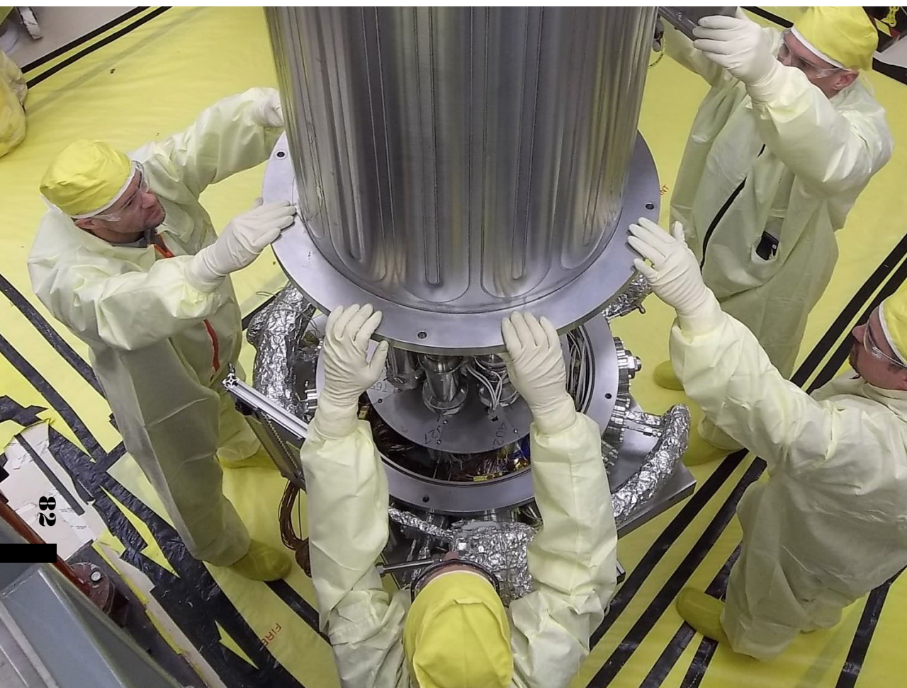
Obr. 5: Inženýři NASA a NNSA umísťují vakuovou komoru kolem reaktoru Kilopower a Stirlingových motorů (systém KRUSTY). (Zdroj: NASA, https://www.nasa.gov )
