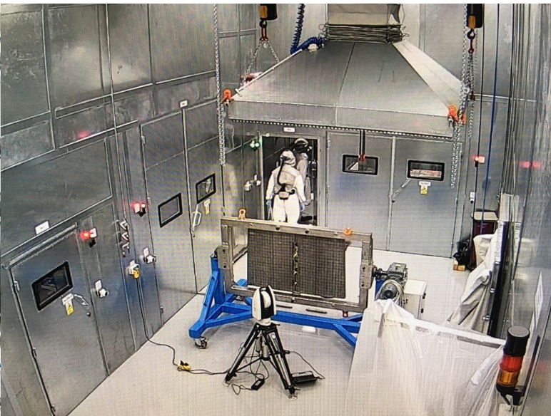
Obr.5: Prototyp panelu první stěny před zavezením do vakuové nádoby (záběr z kamerového systému)
