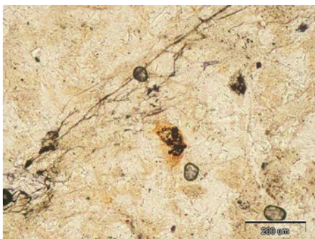
Olomučanské rohovce zahřáté na 400°C. Na obrázku jsou vidět pukliny zahojené oxidy železa.
