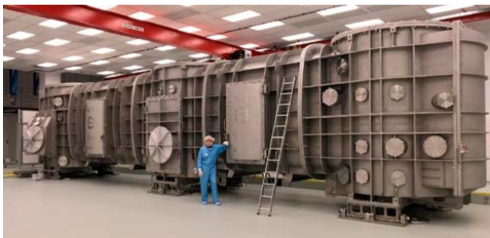
■ Obr. 114 Sestavená vakuová komora kompresoru (délka 18 m, výška 4,2 m, hmotnost 60 tun) 10 PW pulsů v laserové hale L4c centra ELI-Beamlines, září 2019.
