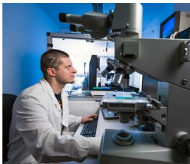
■ Obr. 68 Laboratoř mechanických vlastností povrchů a vrstev ve SLO UP a FZÚ AV ČR, která využívá nanoindentor rozšířený o metodu registrace akustické emise.
