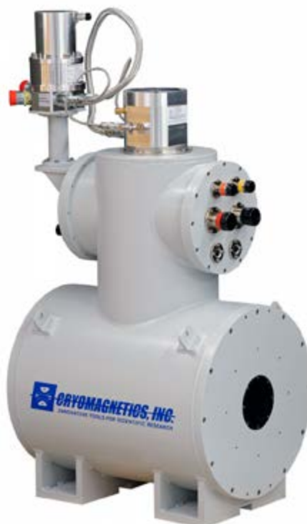
■ Obr. 97 Kryogenní magnet pro Faradayův izolátor vyvíjený pro Bivoj 100 J.
