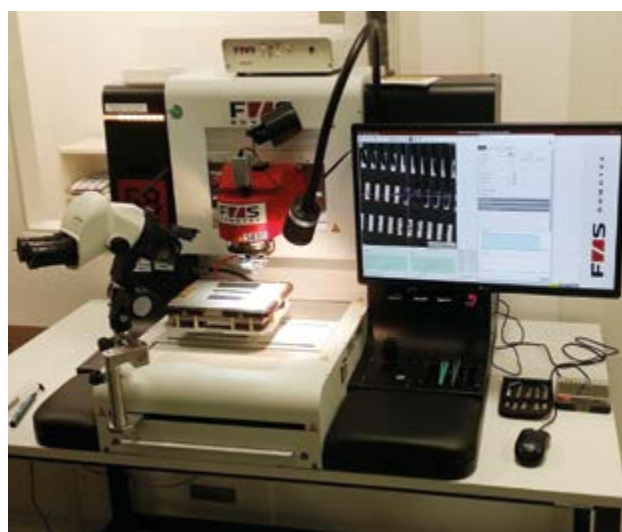
■ Obr. 1 Příprava na bondování stripového křemíkového detektoru typu R0 pro projekt ATLAS ITk v nově zřízené čisté laboratoři pro testování křemíkových detektorů částic.
