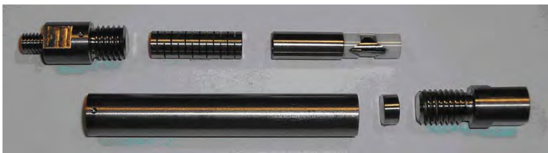
■ Obr. 8 Experimentální uniaxiální tlakové zařízení pro neutronovou difrakci v oblasti nízkých teplot a silných magnetických polí.
