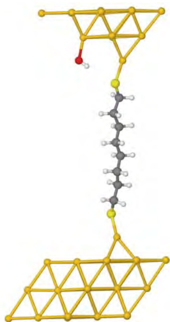
■ Obr. 12 Optimalizovaná atomární struktura molekulárního kontaktu mezi povrchem zlata a hrotem rastrovacího mikroskopu (počítačová simulace).
