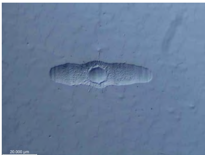
■ Obr. 7 Nomarského (DIC – Differential Interference Contrast) mikrofotografie ablačního otisku svazku rentgenového laseru LCLS v monokrystalickém wolframu olovnatém. Dobře jsou patrné dva prahy: na periferii kráteru jsou ostré kontury netepelné ablace a ve střední části kráteru pak tavení, zčásti ovlivněné termalizovanou frakcí energie při vyšších fluencích. Připomeňme, že optické lasery způsobují nejprve tepelné tavení a až na úrovni vyšších fluencí vyvolávají netepelnou ablaci.
