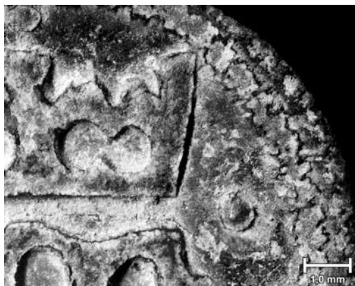
Obr. 2. Makrofotografie falza č. 3 – detail části koruny a litery W s patrnou vrstvou intermetalické fáze obsahující cín v místech nevystavených otěru, s obnaženým měděným jádrem v oblastech s vyvýšeným reliéfem a s typickou podpovrchovou korozí.
