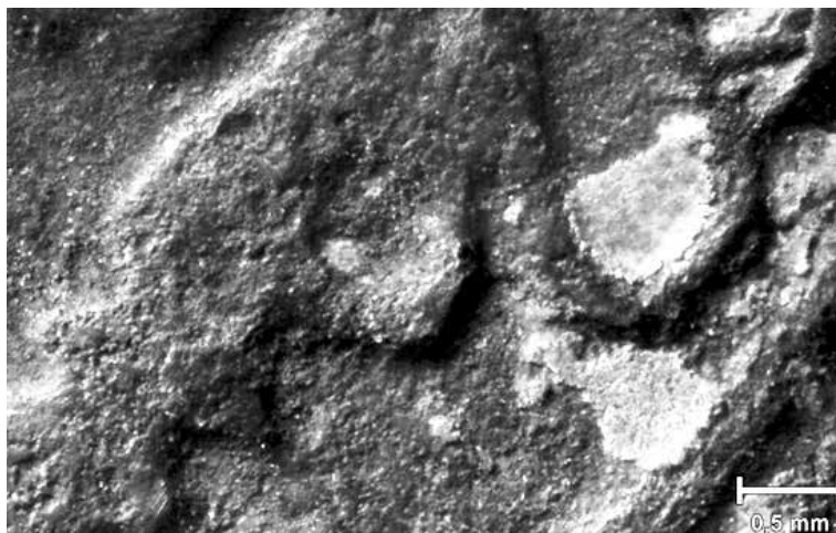
Obr. 4. Makrofotografie amalgamačního pokovení na líci mince č. 11 (obr. 3:11). Pro studium detailů a získání záběrů byl použit stereomikroskop MST 127 (použity objektivy \times 1 a \times 5 ) v kombinaci s digitalizačním USB nástavcem Digital Eyepiece (2MPx, senzor 1/3"). Výsledné snímky byly vytvořeny superpozicí jednotlivých záběrů s využitím softwaru Image Composite Editor (verze 2.0.3.0).
